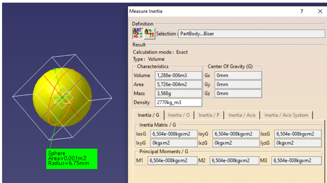
Slika 11. Model bisera i njegove specifikacije u CATIA V5
