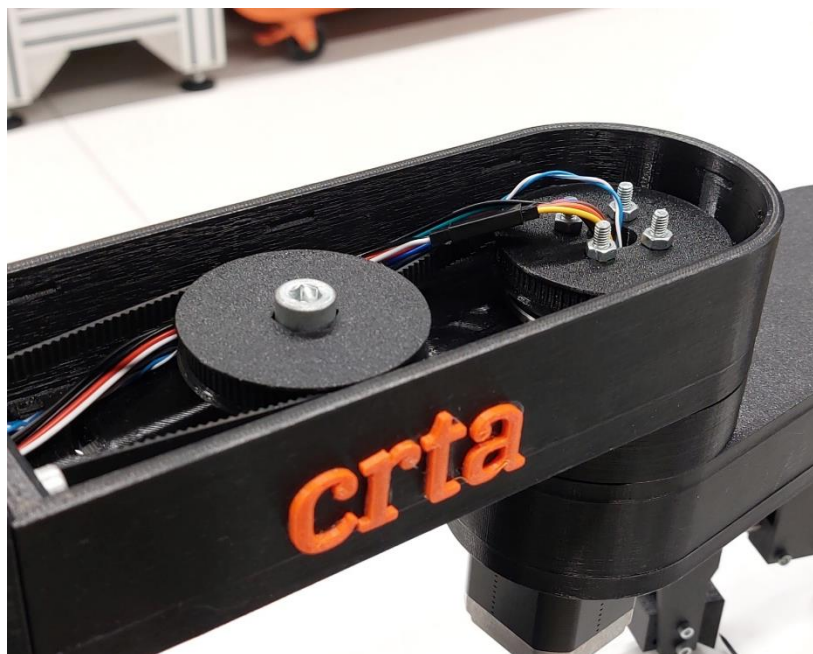
Slika 3.13. Ožičenje ruke SCARA robota
