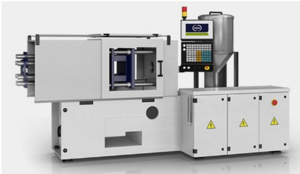
Slika 8. Primjer ubrizgavalice za injekcijsko prešanje metala [7]
