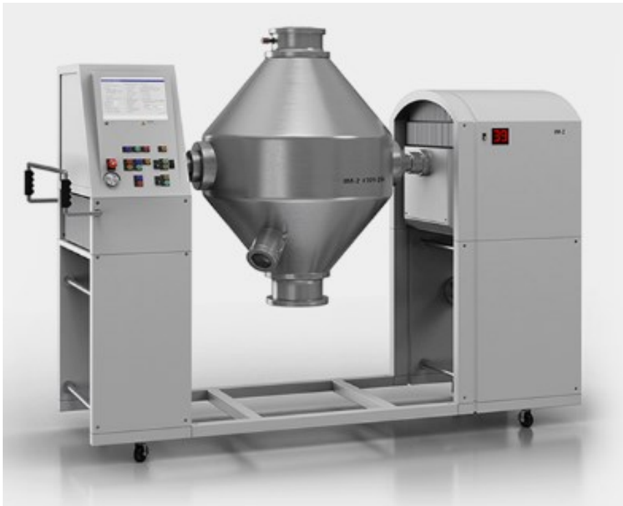
Slika 7. Primjer stroja za miješanje praha i veziva [7]
