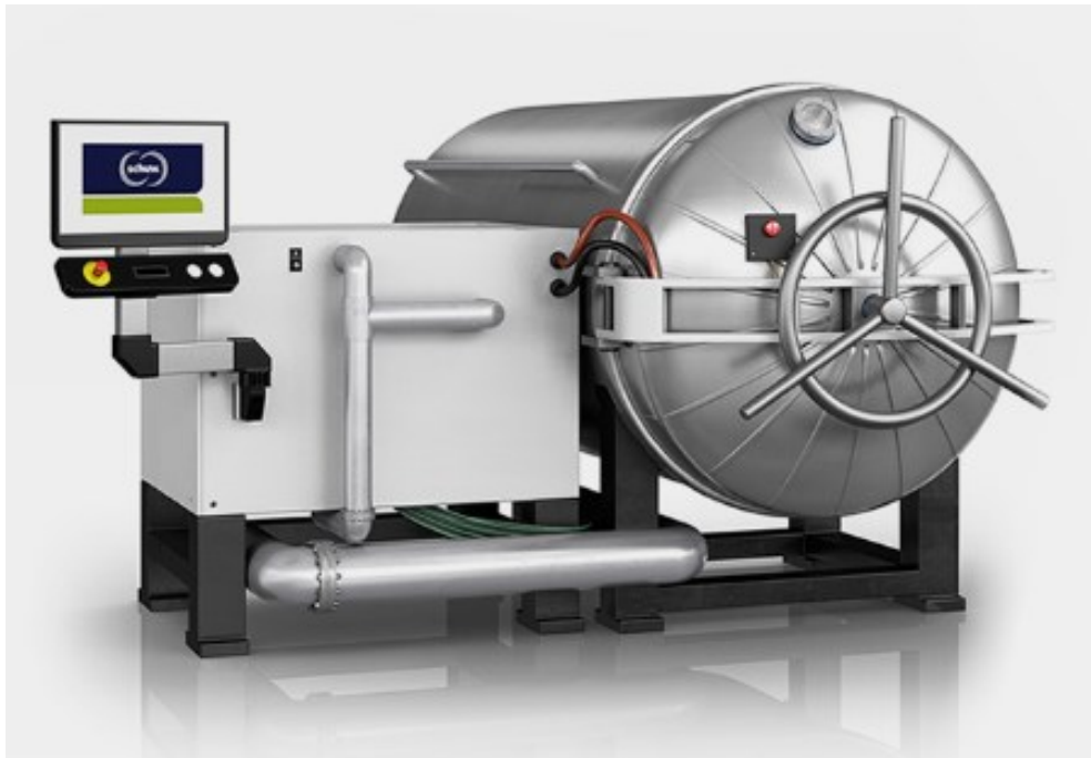
Slika 9. Primjer komore za odvajanje veziva u zaštićenoj atmosferi [7]
