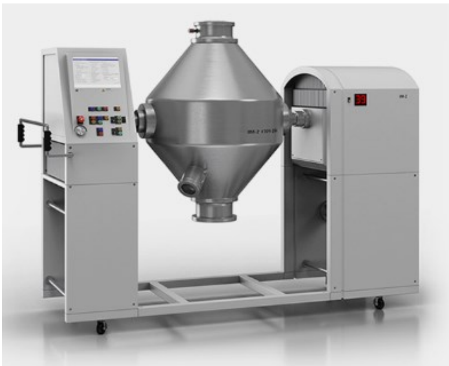
Slika 7. Primjer stroja za miješanje praha i veziva [7]
