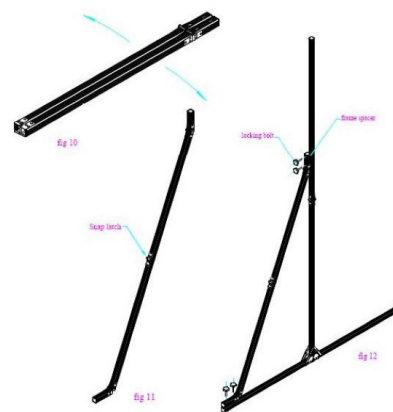
Slika 3.1.13. Prikaz različitih mogućnosti nožnih potpornja „QuickStand“ proizvoda.
