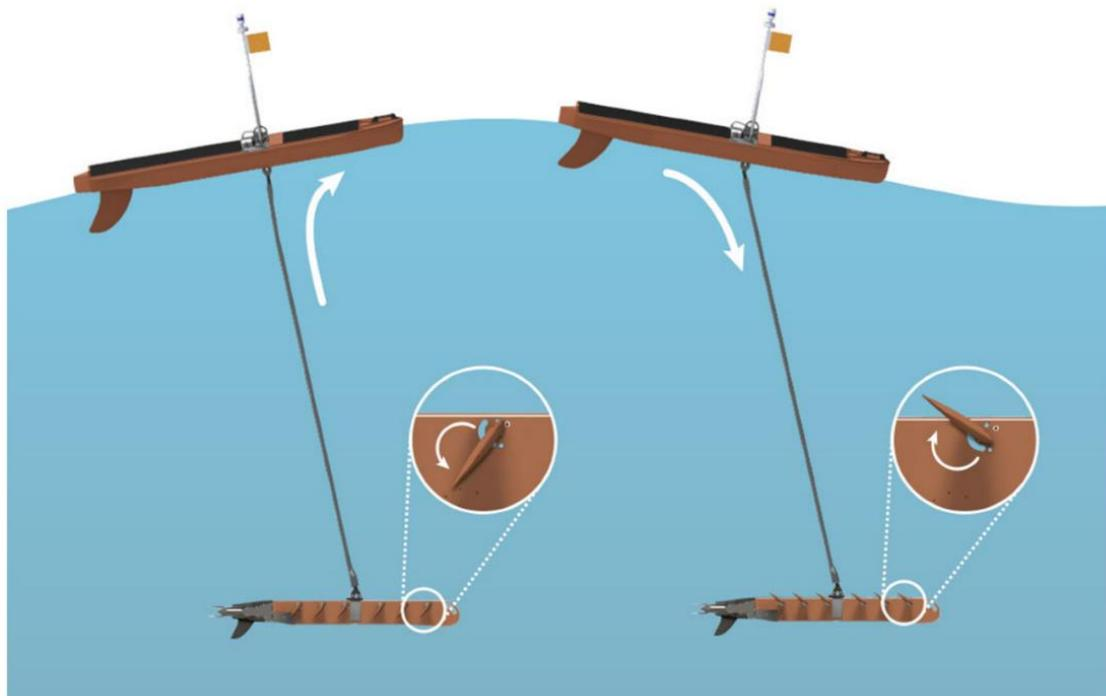
Slika 5. Princip rada robota Wave Glider [25]
