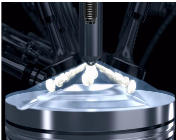
Slika 8. Pasivna pretkomora tvrtke MAHLE Powertrain [10]
