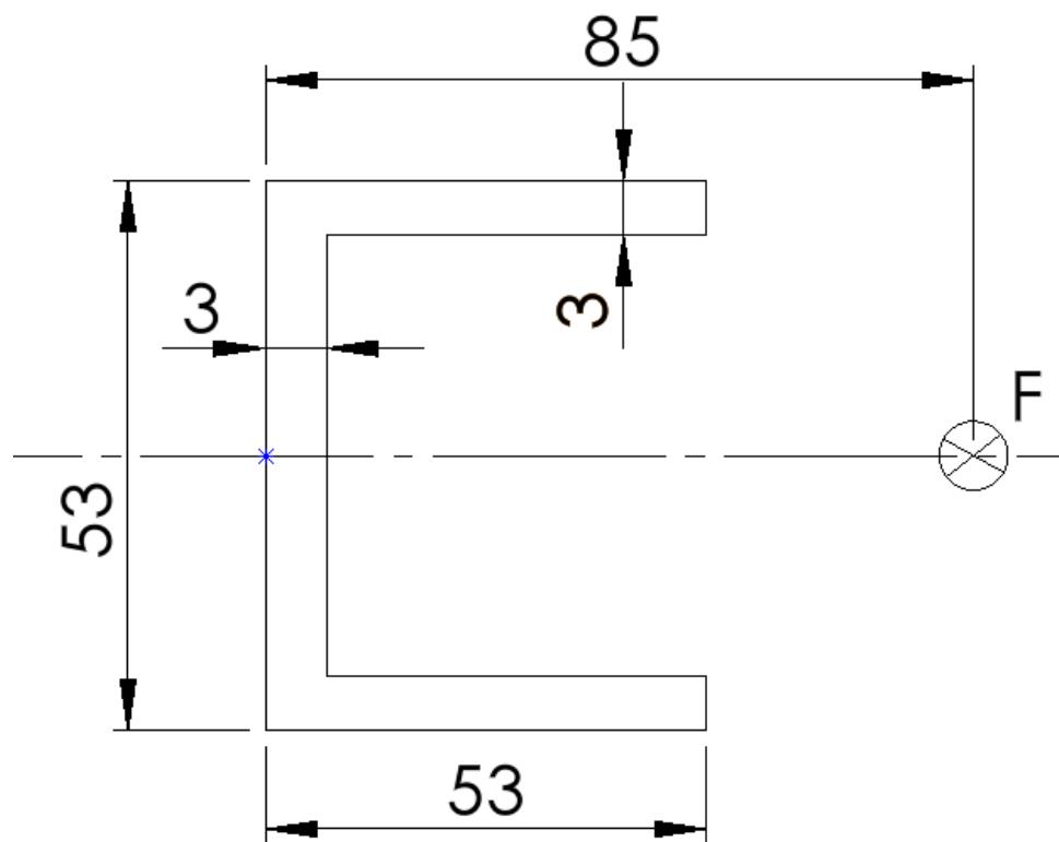
Slika 61. Skica zavara i opterećenja koje djeluje na zavar
