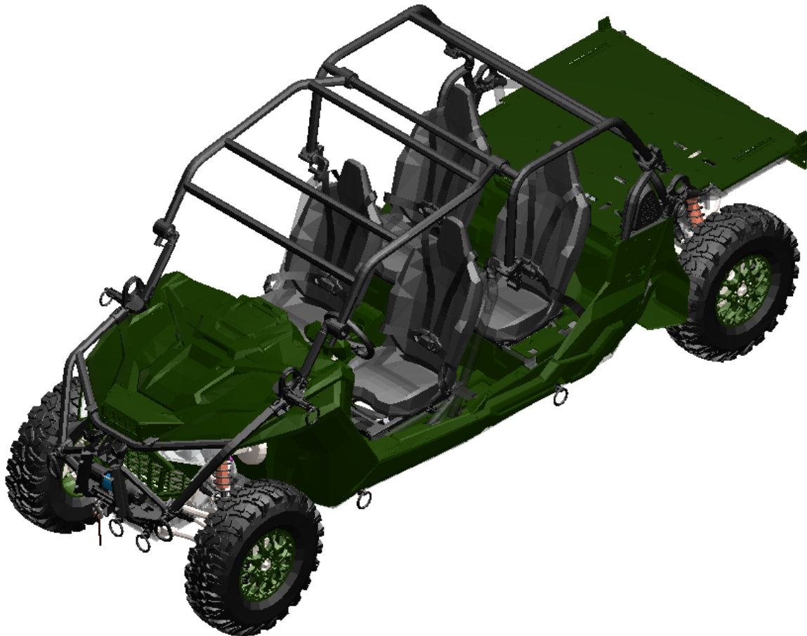
Slika 7: Solidworks model vozila Polaris MRZR Alpha 4
