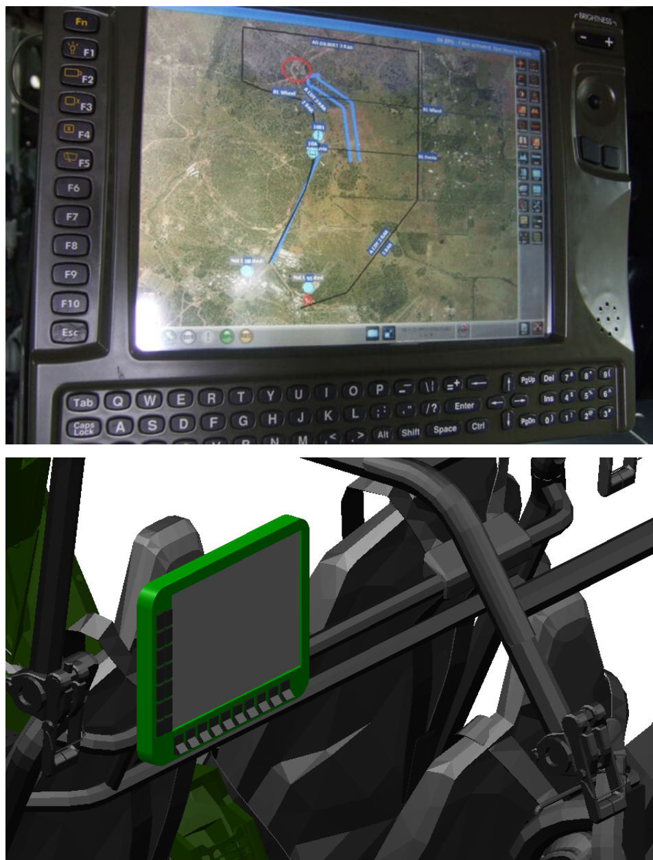
Slika 17: Sustav upravljanja bojištem: a) LAND 75 Phase 3.4 Battlefield Command Support System [25], b) model sustava u vozilu
