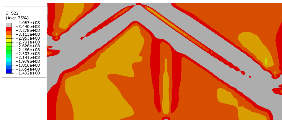
Slika 52. Normalna komponenta napreznja \sigma_y - 122980 C3D8I elemenata
