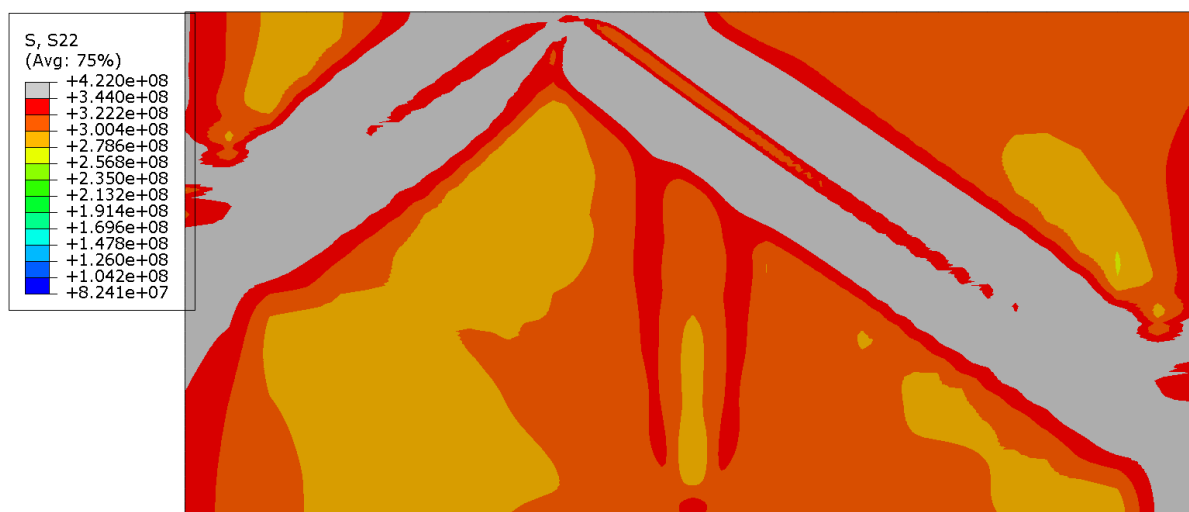
Slika 60. Normalna komponenta napreznaja \sigma_y - 83448 C3D8I elemenata
