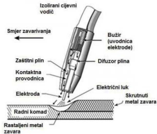
Slika 4. MAG zavarivanje [8]
