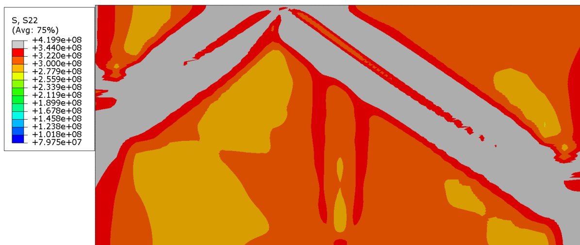
Slika 59. Normalna komponenta napreznaja \sigma_y - 48960 C3D8I elemenata
