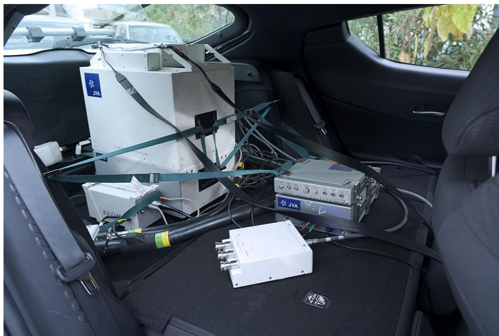
Slika 4 PEMS uređaj montiran u prtljažnik automobila [5]
