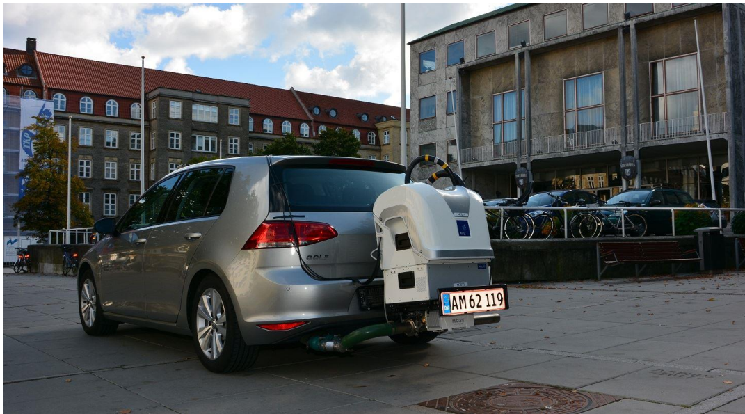
Slika 3 PEMS uređaj montiran na kuku automobila [4]
