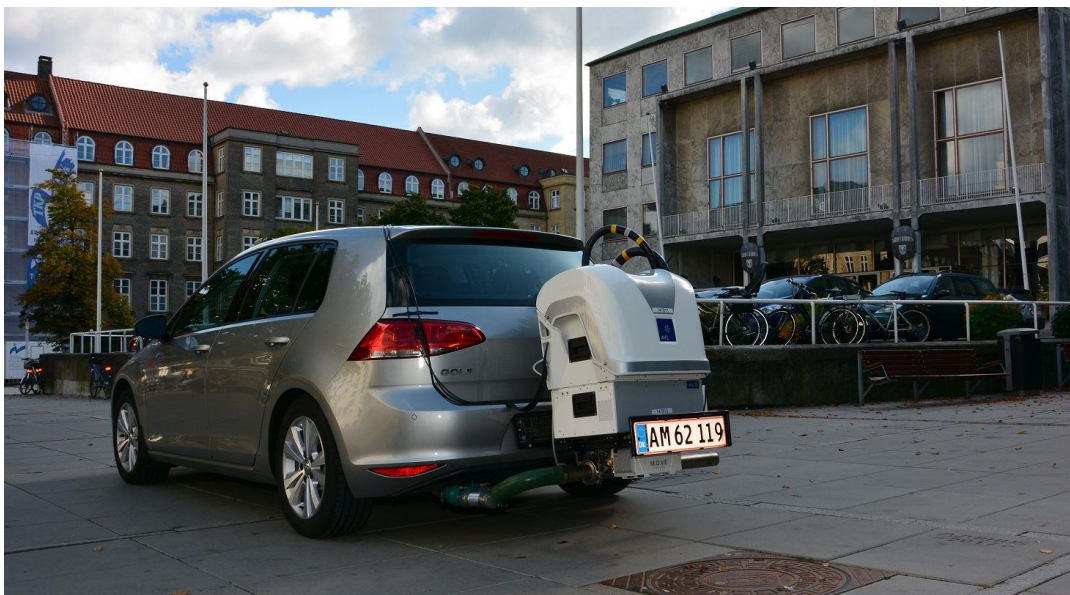
Slika 3 PEMS uređaj montiran na kuku automobila [4]
