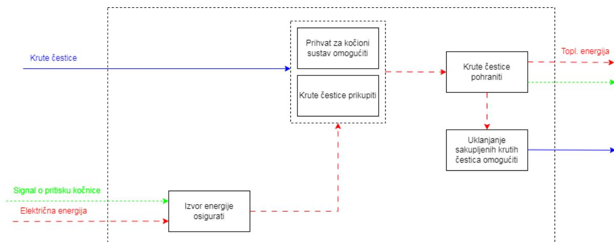
Slika 26. Funkcijska struktura sustava za prikupljanje krutih čestica s kočnica osobnih vozila
