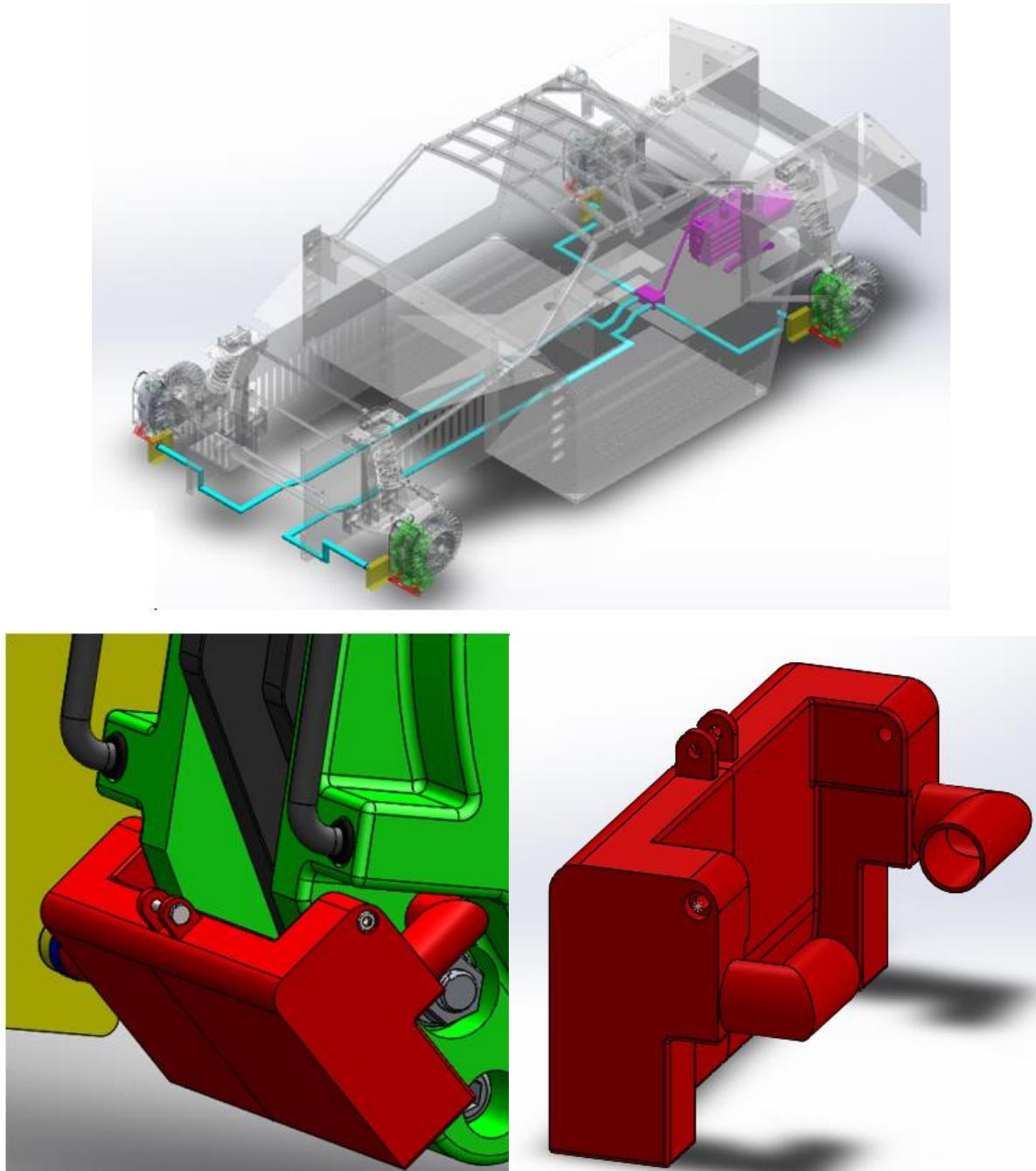
Slika 35. 3D CAD model za disk kočnice
