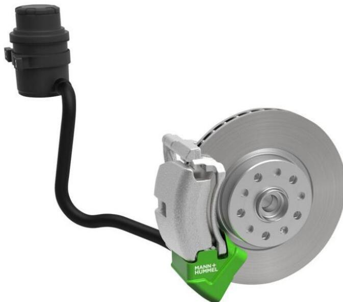
Slika 7. Sustav s filterom na disk kočnici
