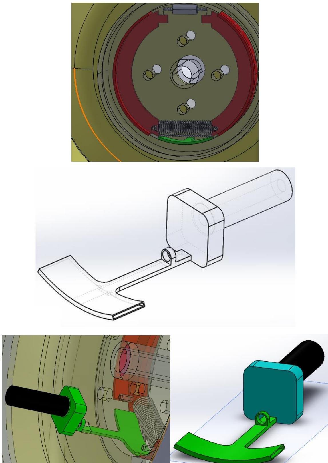
Slika 36. 3D CAD model sustava za bubenjske kočnice
