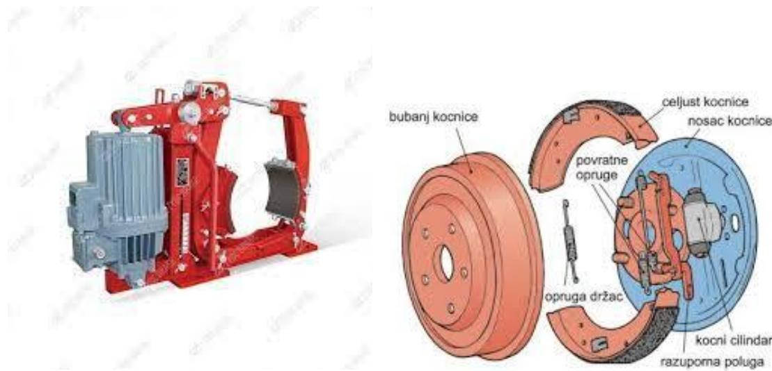
**Slika 2. Bubanjska kočnica**
