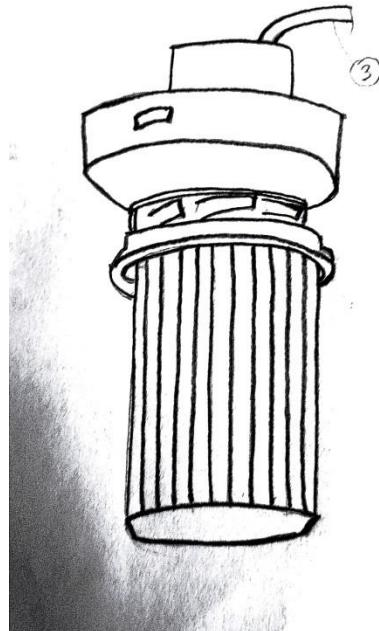
Slika 28. Koncept 1 prikaz vakuumske pumpe i filtera
