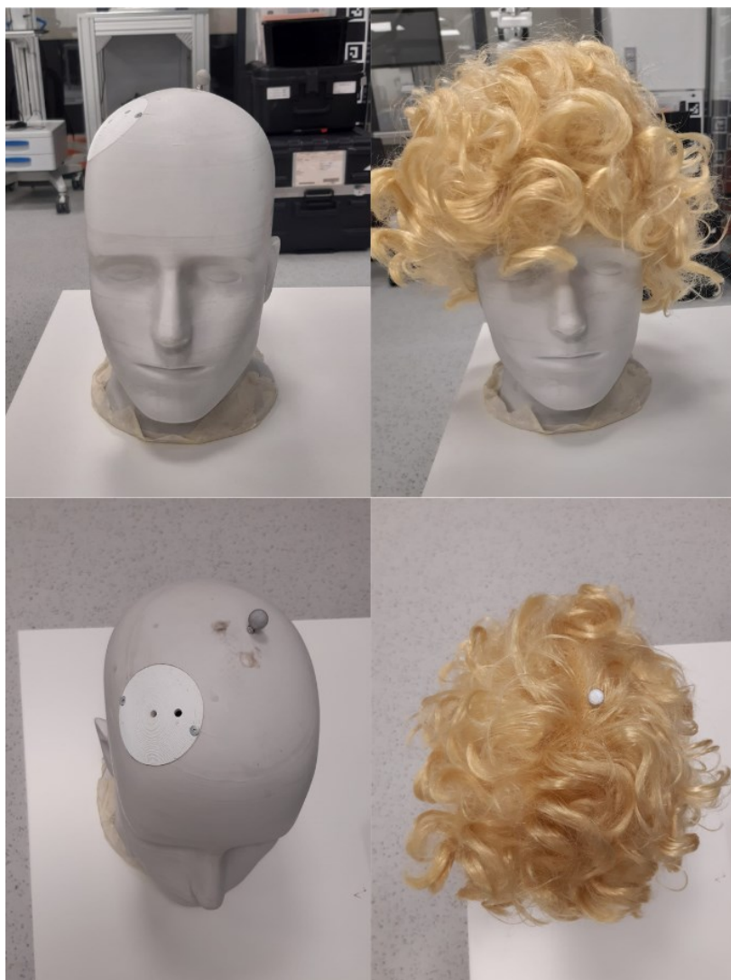
Slika 12. Plastična replika ljudske lubanje korištena kao fantom
