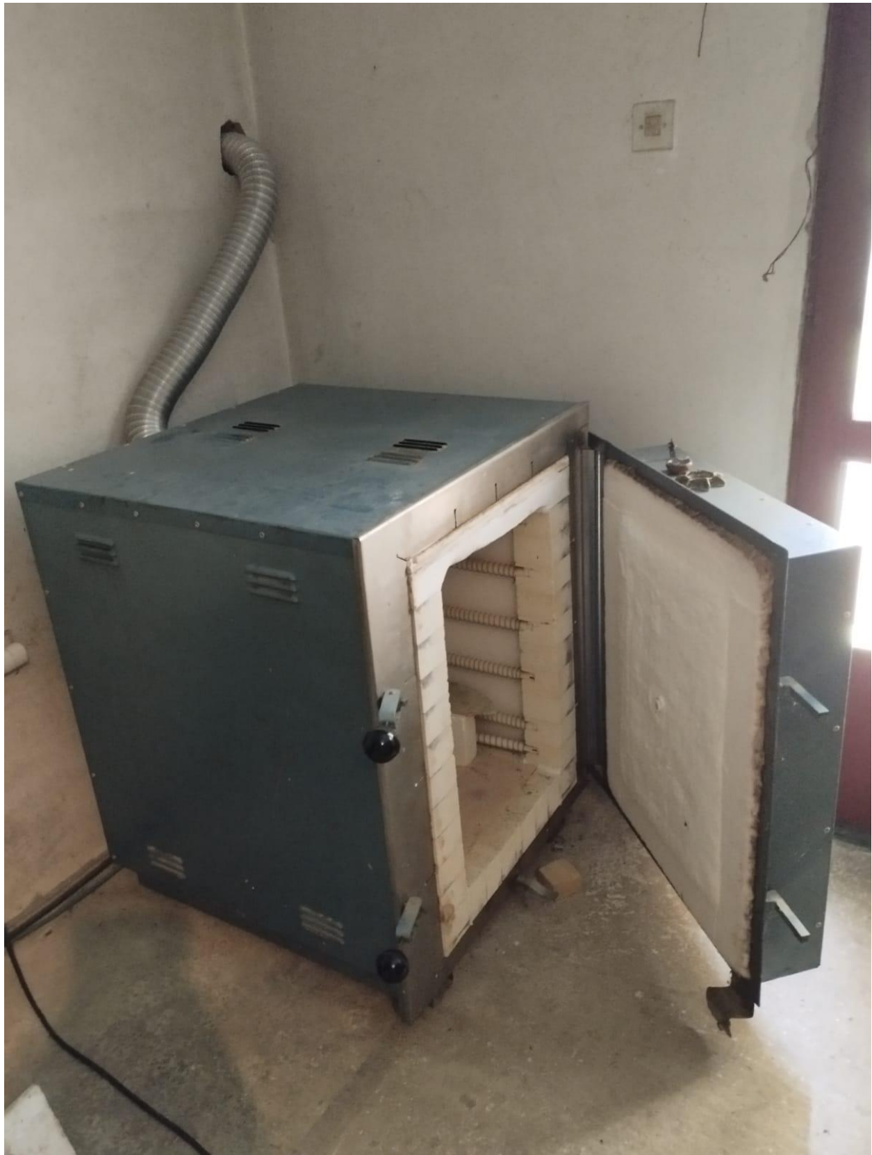
Slika 18. Keramička peć – otvorena
