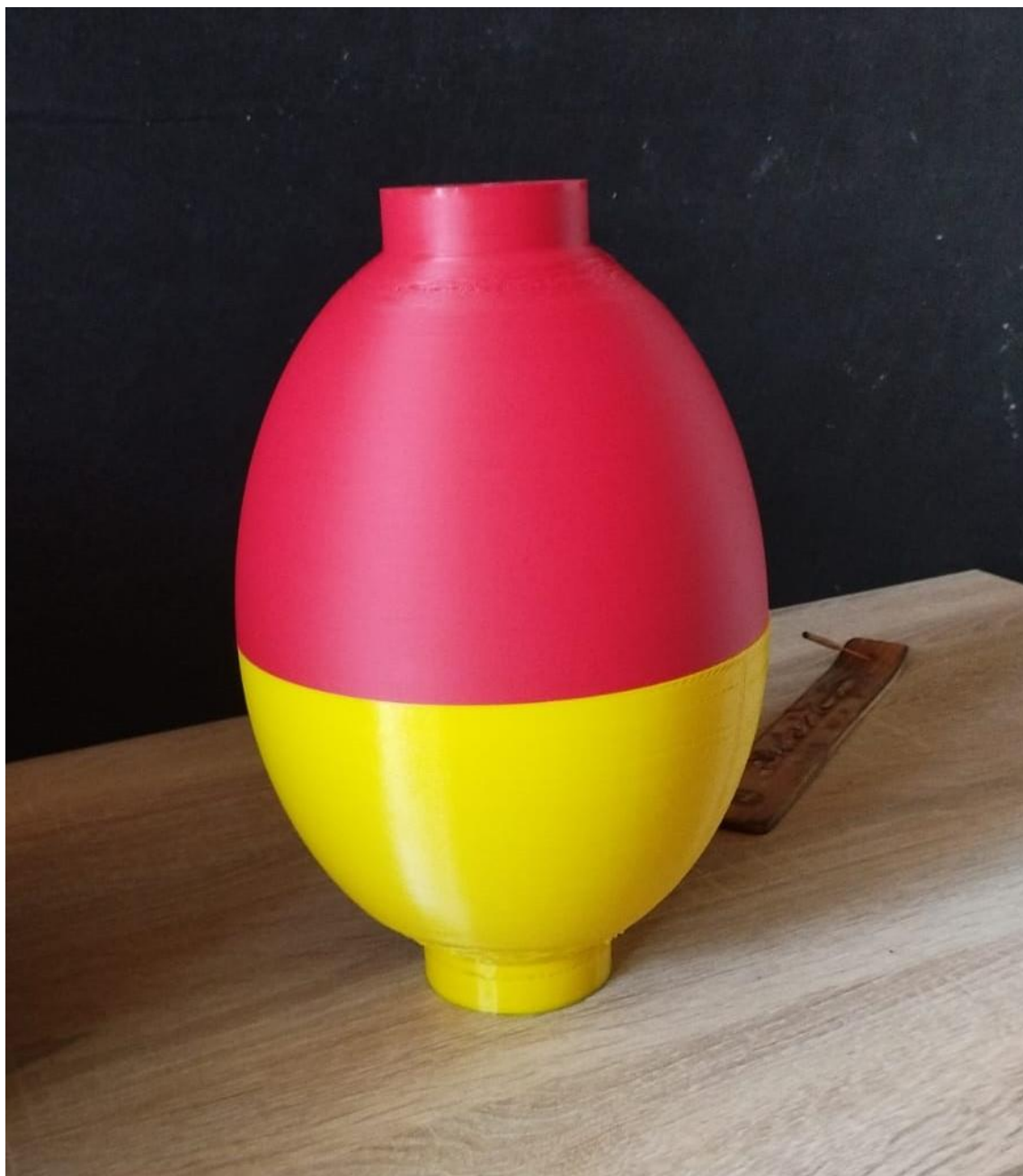
Slika 24. Kalup izveden u četiri dijela
