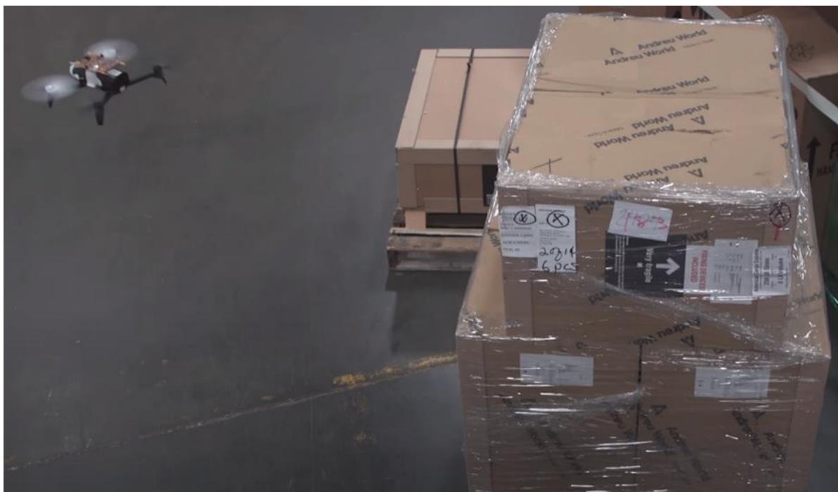
Slika 27. Prikaz veličine drona i očitavanje RFID tagova [47]
