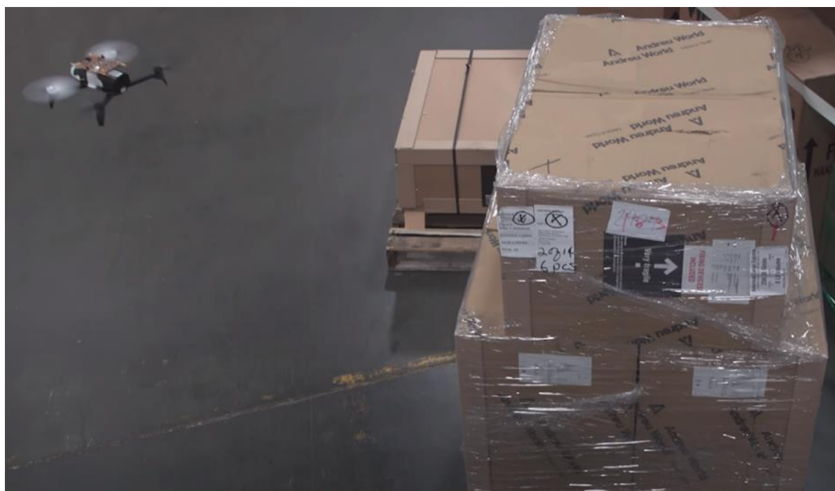
Slika 27. Prikaz veličine drona i očitavanje RFID tagova [47]
