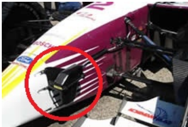
Slika 4.1: Optički senzor kuta bočnog klizanja
