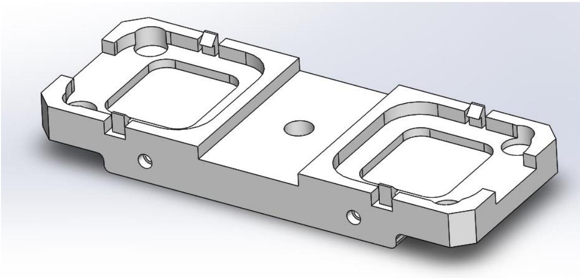
**Slika 4. Nosač mjernih čelija**
