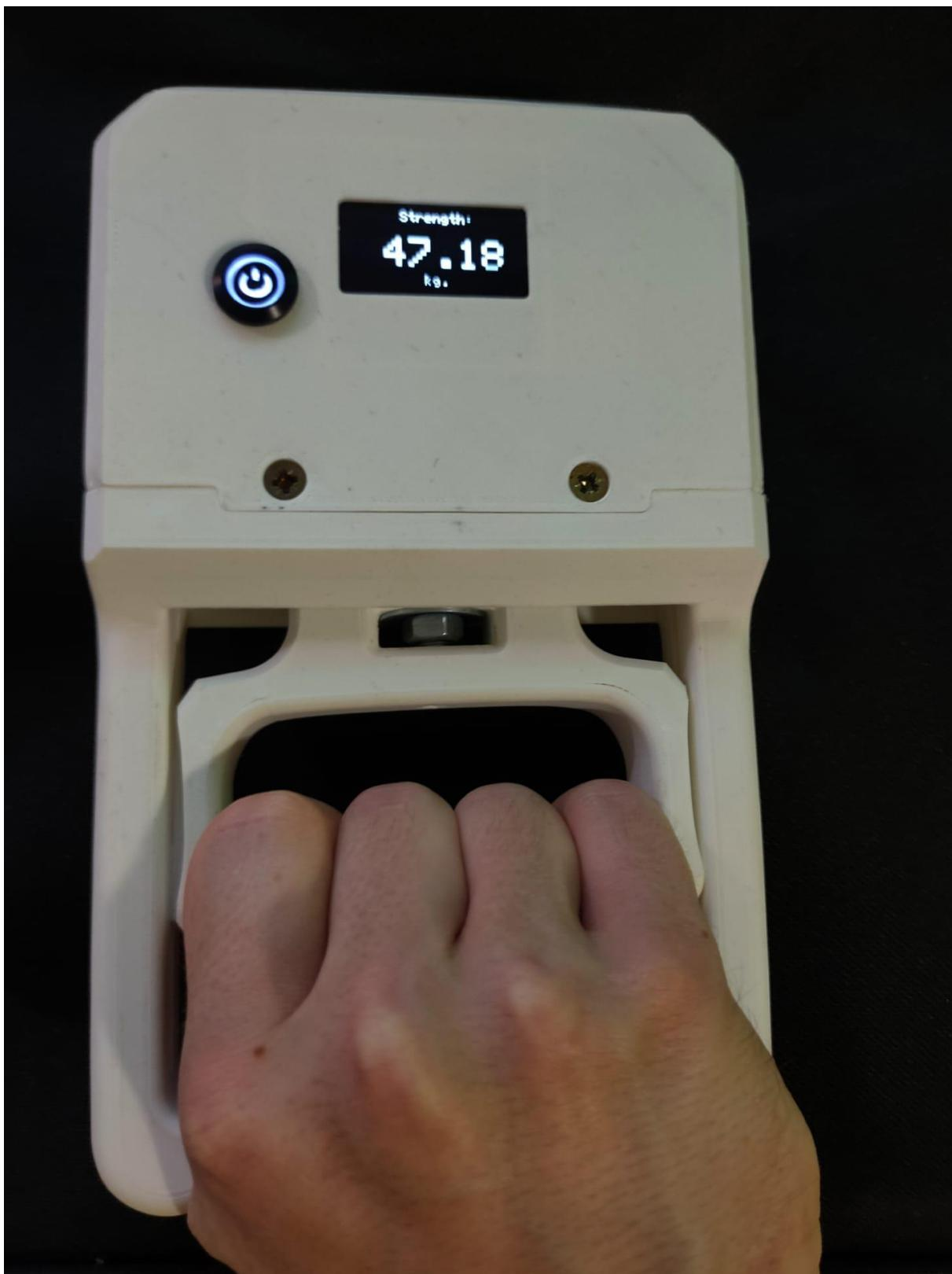
Slika 44. Testiranje ručnog dinamometra
