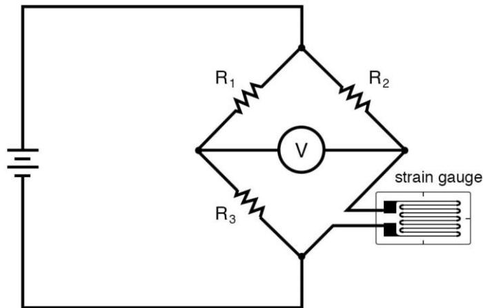
Slika 19. Četvrt-most konfiguracija Wheatstoneovog mosta s tenzometarskom trakom [9]
