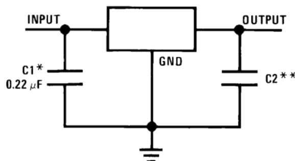
**Slika 31. Shema spajanja regulatora napona [12]**
