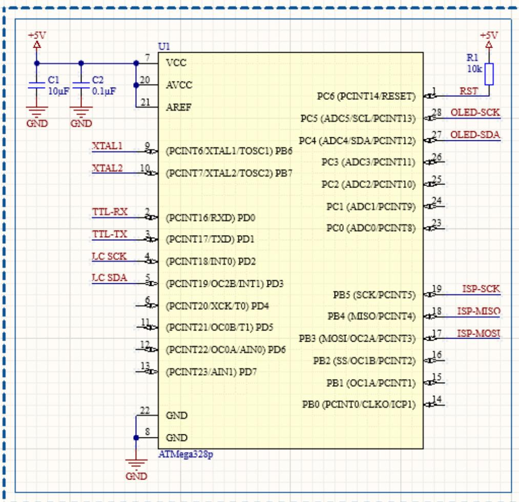
Slika 33. Shema spajanja mikrokontrolera
