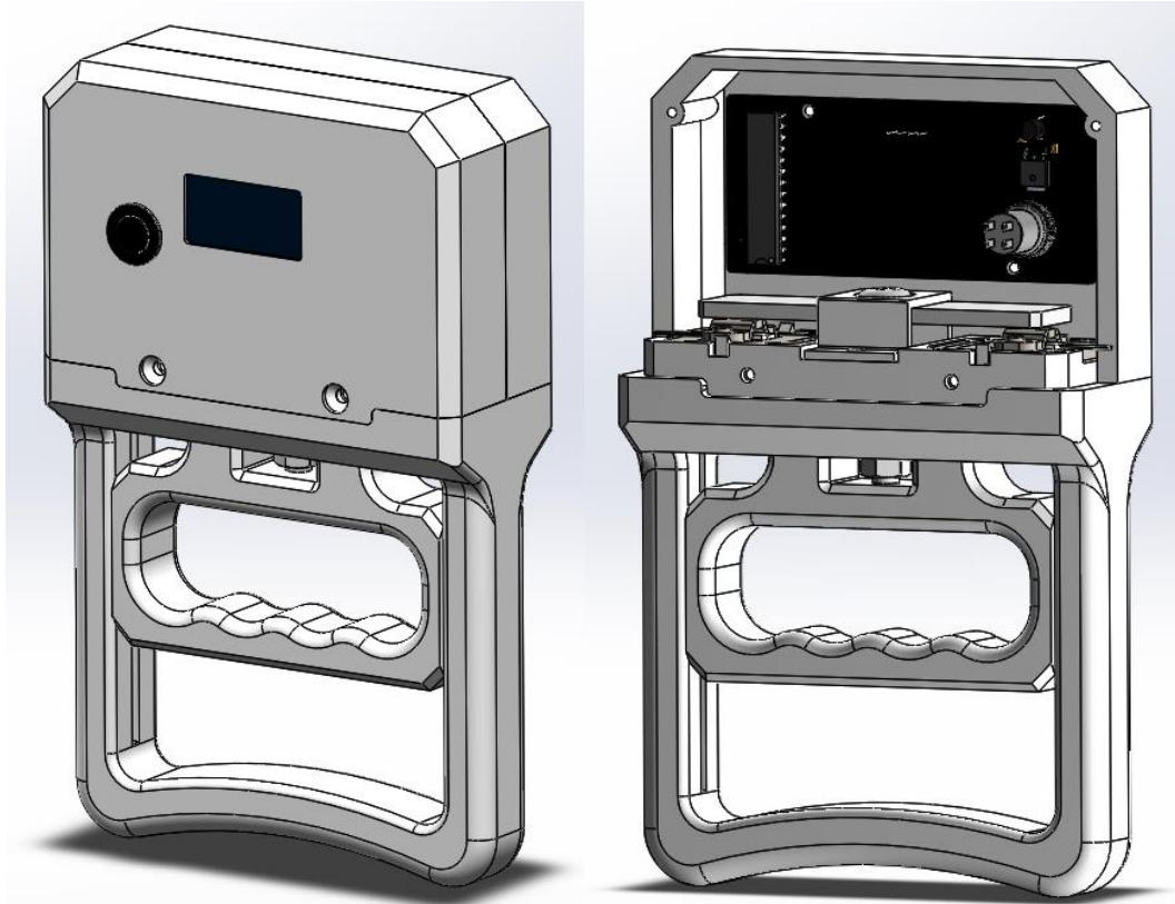
Slika 41. 3D model ručnog dinamometra s tiskanom pločicom
