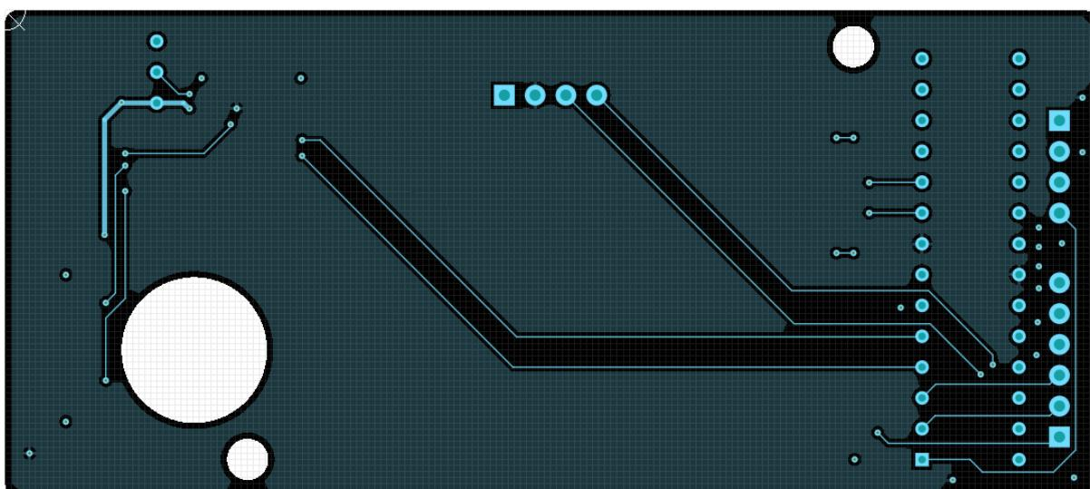
Slika 37. Treći (SIGNAL) sloj tiskane pločice
