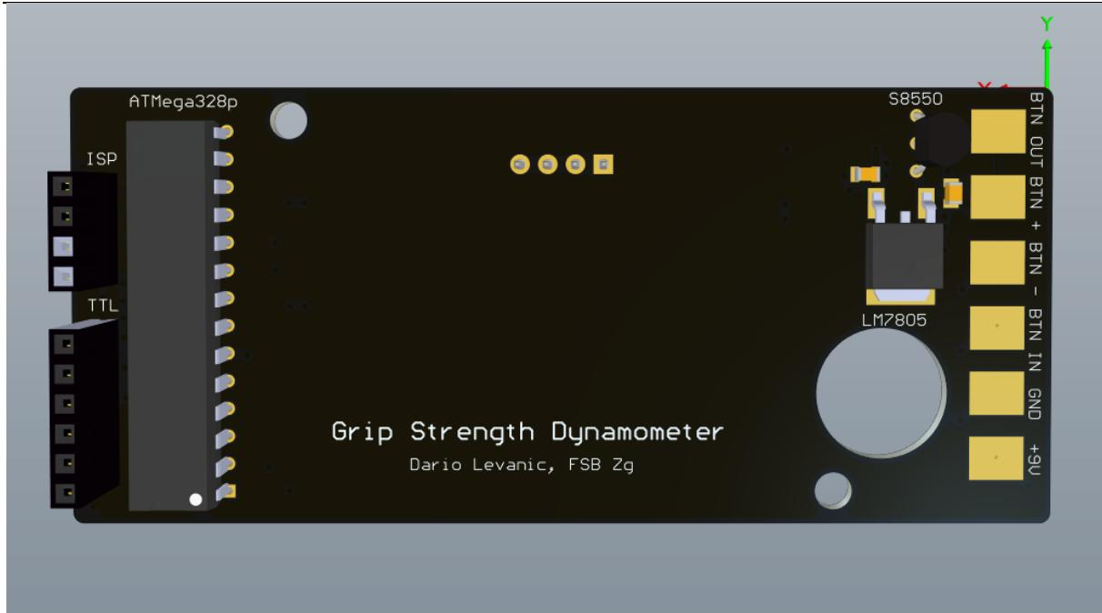
Slika 40. 3D prikaz stražnjeg dijela tiskane pločice
