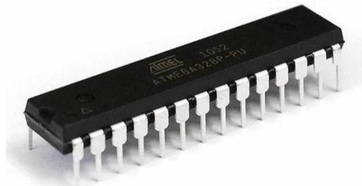
Slika 26. Mikroprocesor ATmega328-PU
