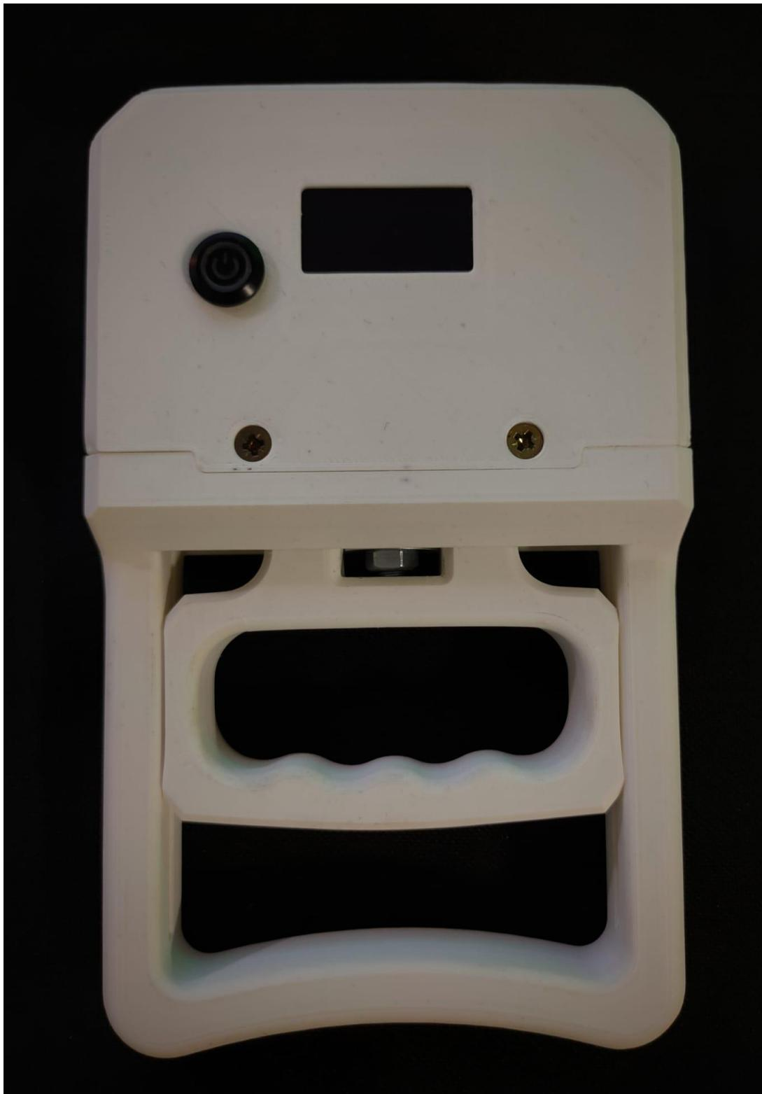
Slika 42. Fizički izgled ručnog dinamometra
