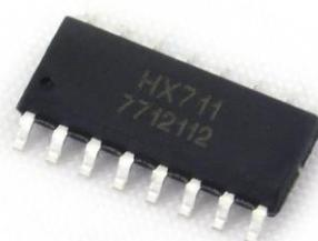
Slika 25. HX711 analogno-digitalni pretvornik
