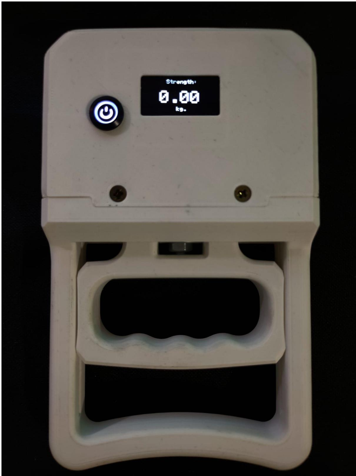
Slika 43. Uključen i neopterećen dinamometar
