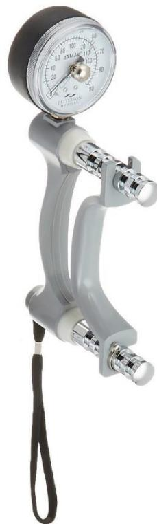
**Slika 2. Primjer hidrauličkog ručnog dinamometra**
