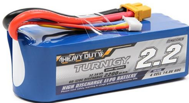
Slika 13. Turnigy nano-tech 2200 mAh 4S LiPo baterija [8]
