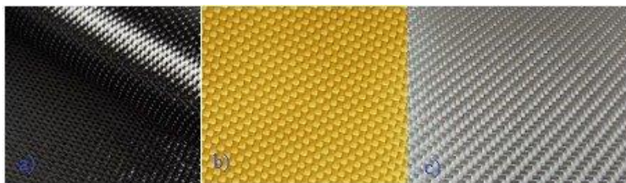
Slika 7. Ugljična, aramidna i staklena vlakna [11]
