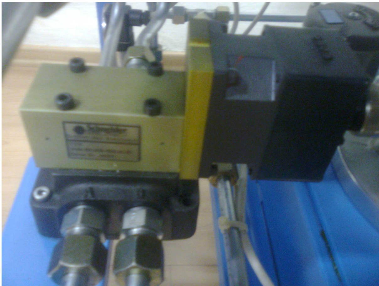
Slika 3.5. Prikaz servoventila koji se koristi za regulaciju
