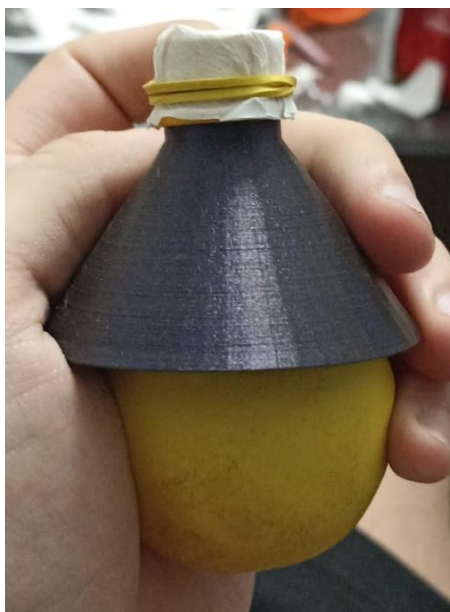
Slika 38. Montaža fleksibilne hvataljke
