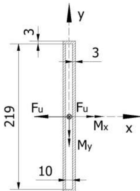
Slika 23. Prikaz opterećenja na zavar nosača izravnavajuće užnice
