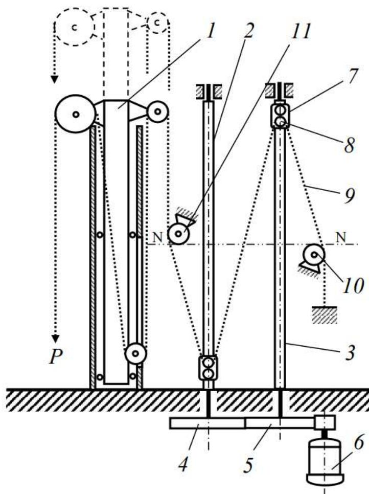
Slika 3. Shema teleskopskog mehanizma pumpe za crpljenje ulja [3]
