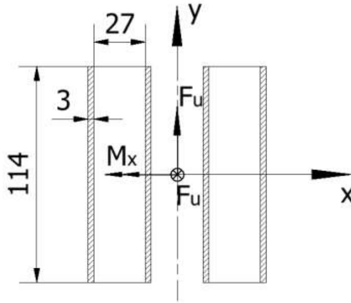
Slika 24. Prikaz opterećenja na zavar izravnavajuće užnice
