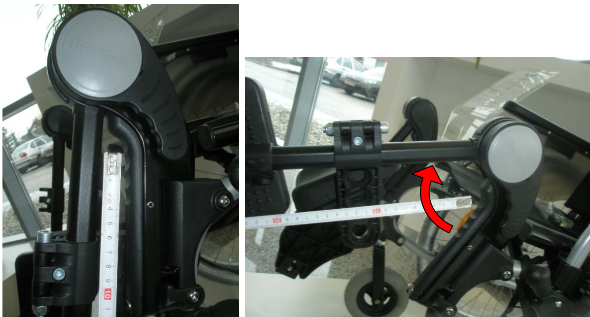
Slika 13 Odmorište za noge koje kod modela 4 omogućuje brzu i jednostavnu promjenu te velik broj mogućih kuteva odmorišta za noge
