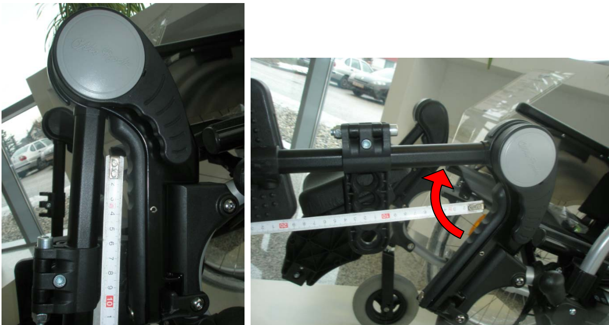
Slika 13 Odmorište za noge koje kod modela 4 omogućuje brzu i jednostavnu promjenu te velik broj mogućih kuteva odmorišta za noge
