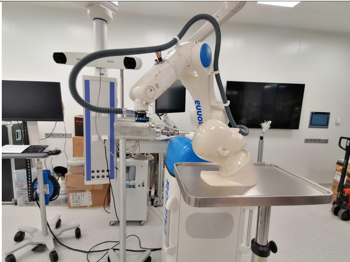
Slika 63. Prototip bušilice i robotski sustav RONNA
