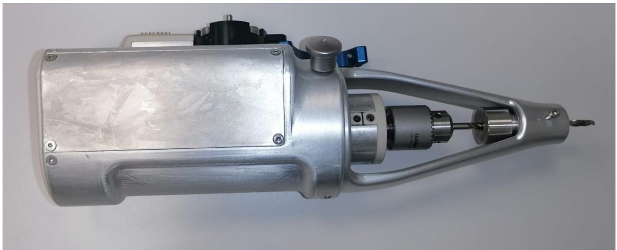
**Slika 62.** Prototip bušilice
