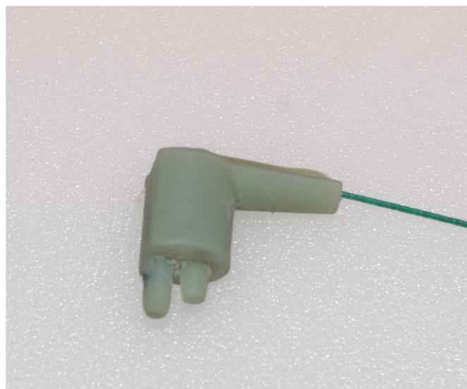
Slika 38. Termopar K tipa [10]
