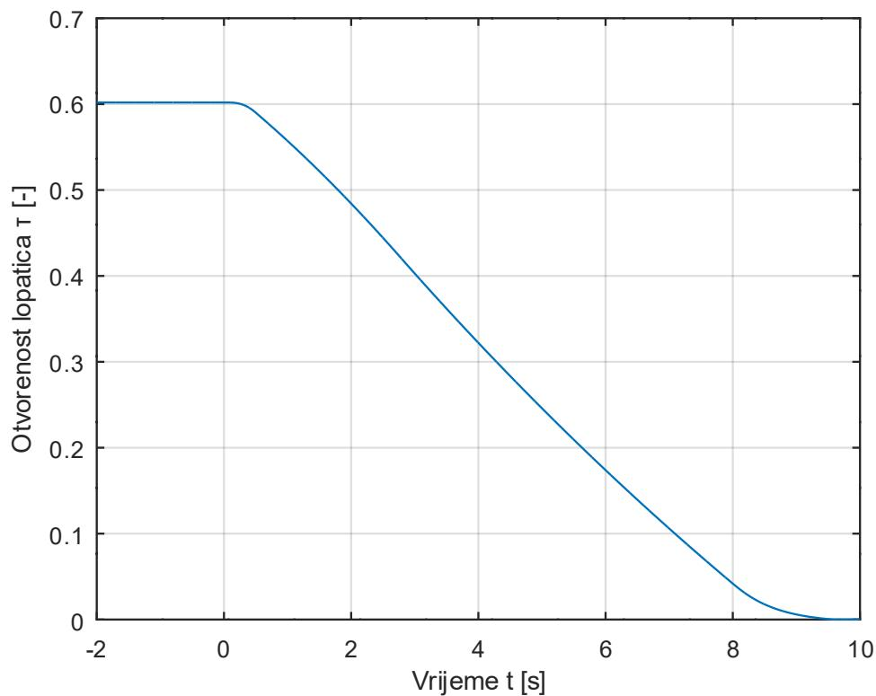
Slika 25. Otvorenost statorskih lopatica nakon ispada generatora
