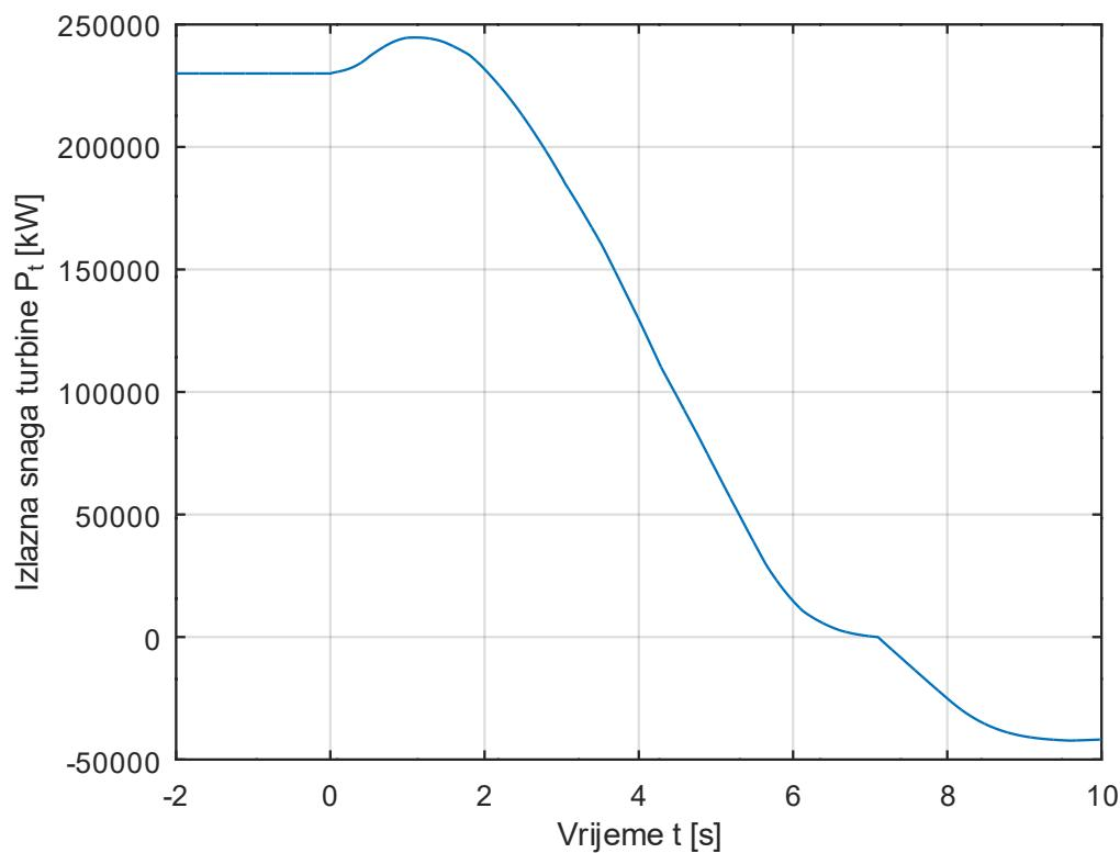
**Slika 27.** Izlazna snaga turbine nakon ispada generatora
