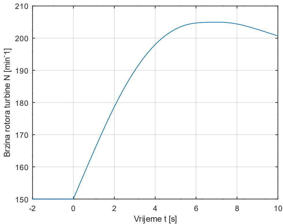
Slika 24. Brzina vrtnje rotora nakon ispada generatora
