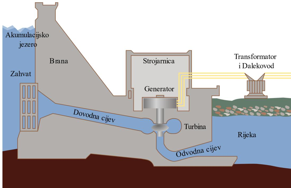
Slika 1. Shema hidroelektrane [3]
