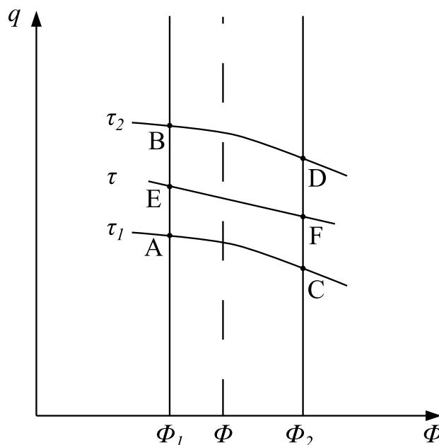
Slika 10. Interpolacija turbineske karakteristike protoka [1]
