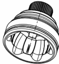
Slika 52. Prirubnica pogonskog vratila na strani kotača, GKN VL125
