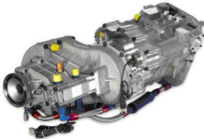
Slika 48. Mjenjač s razvodnikom snage, SADEV SC90-24, [5.]
