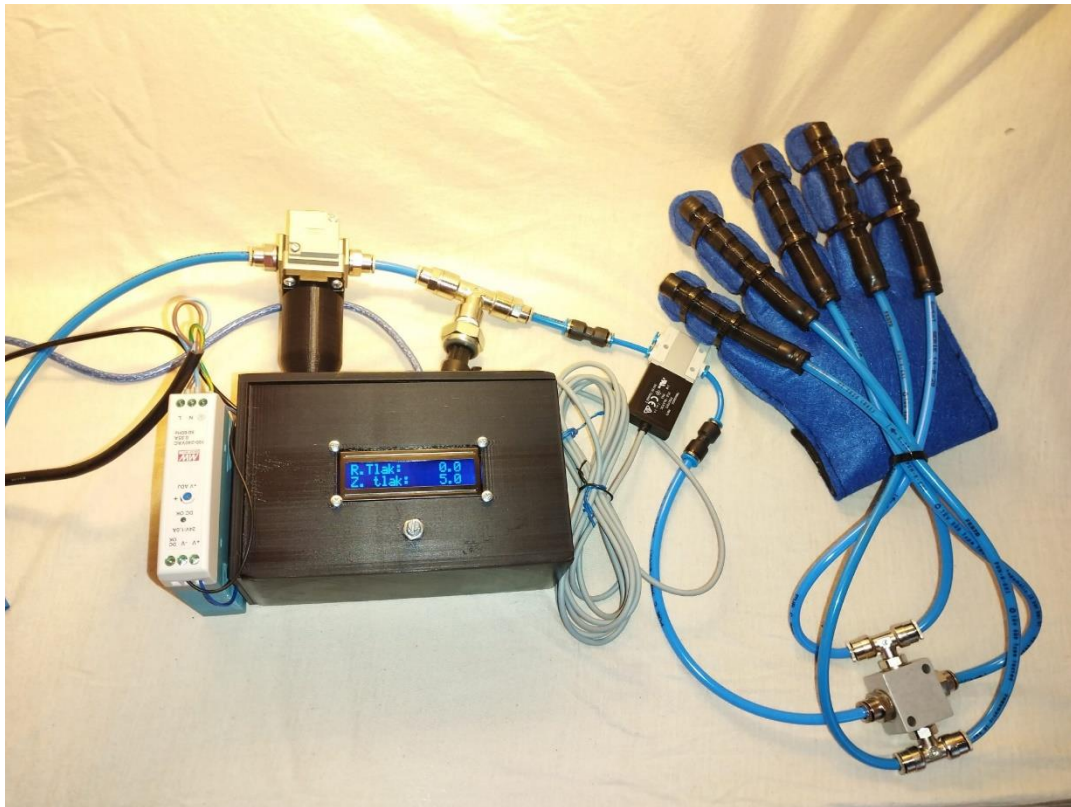
Slika 3 Konstrukcijska izvedba pneumatske rukavice
