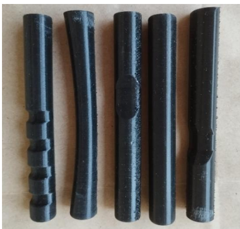
Slika 20 Aktuatori od TPU plastike
