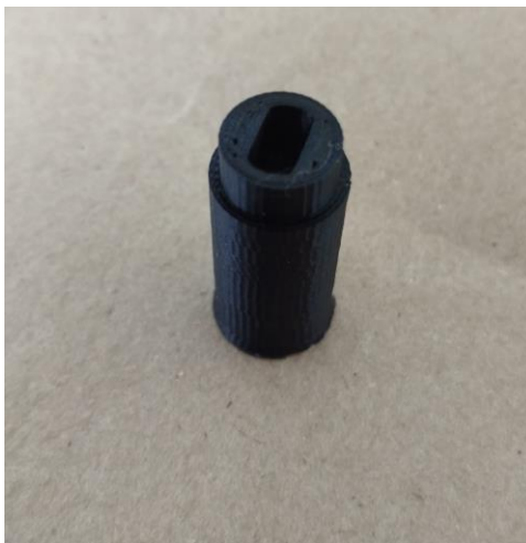
Slika 19 Spojka između motora i regulatora tlaka
