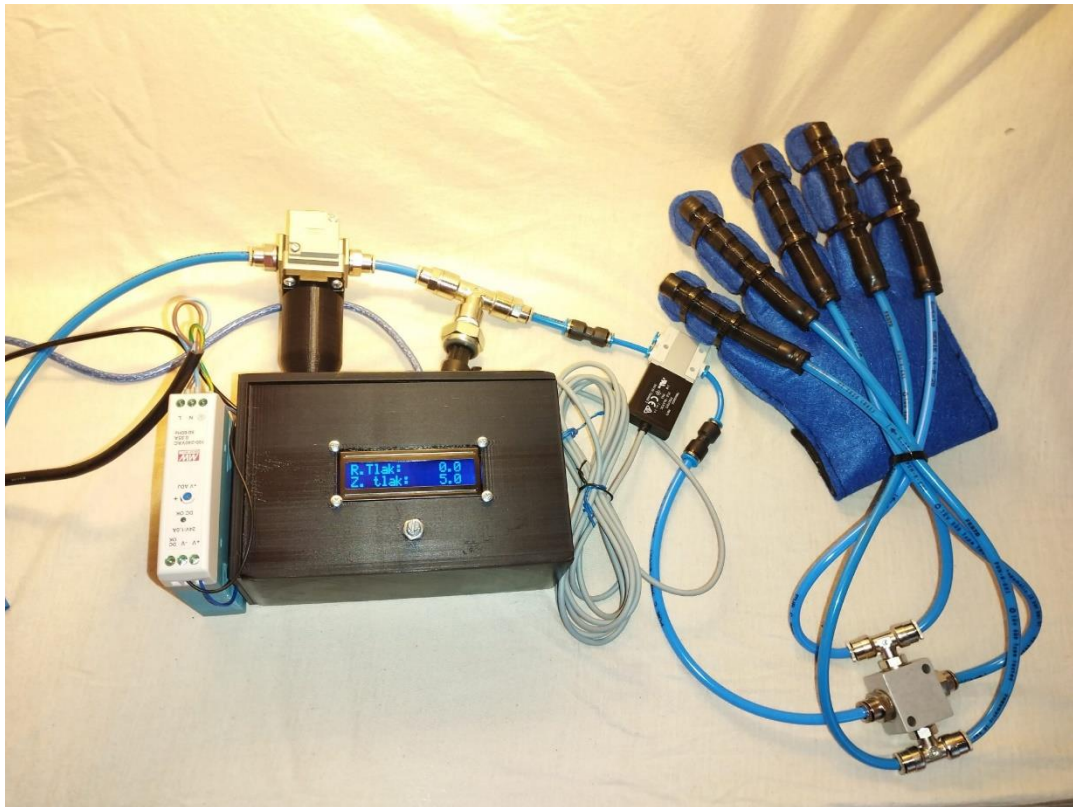
Slika 3 Konstrukcijska izvedba pneumatske rukavice
