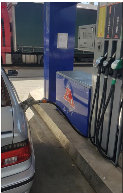
Slika 22. Proces punjenja ukapljenog naftnog plina (Foto: Dominik Dragutin Fojs)
