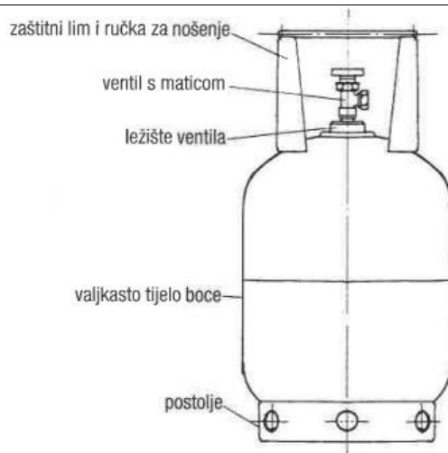
Slika 13. Osnovni dijelovi plinske boce mase 10 kg [9]
