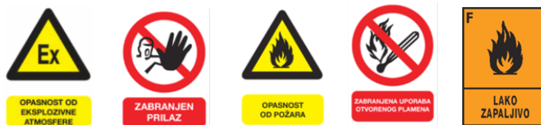
Slika 25. Primjer znakova sigurnosti prilikom rada s ukapljenom naftnim plinom [22]
