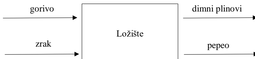
Slika 1. Shematski prikaz ložišta, adaptirano prema [5]
