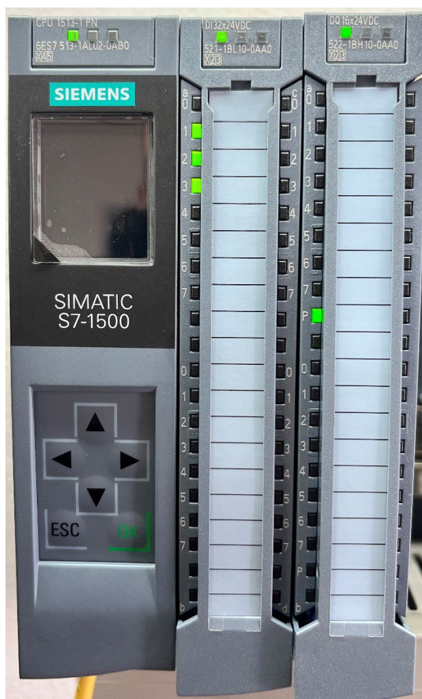
Slika 2. SIEMENS PLC S7-1513-1 PN
