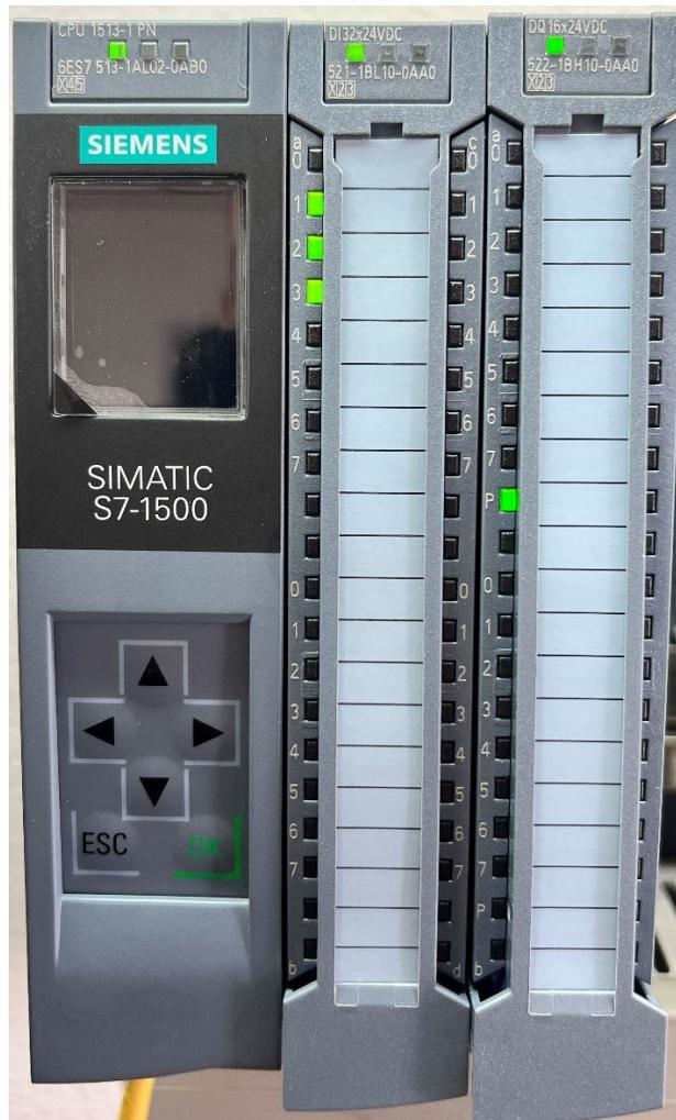
**Slika 2. SIEMENS PLC S7-1513-1 PN**
