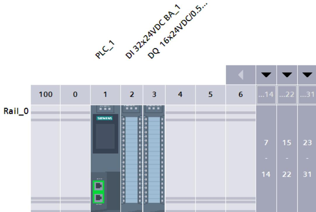
**Slika 15.** Prikaz u „Device view“ nakon dodavanja ulaznog i izlaznog modula
