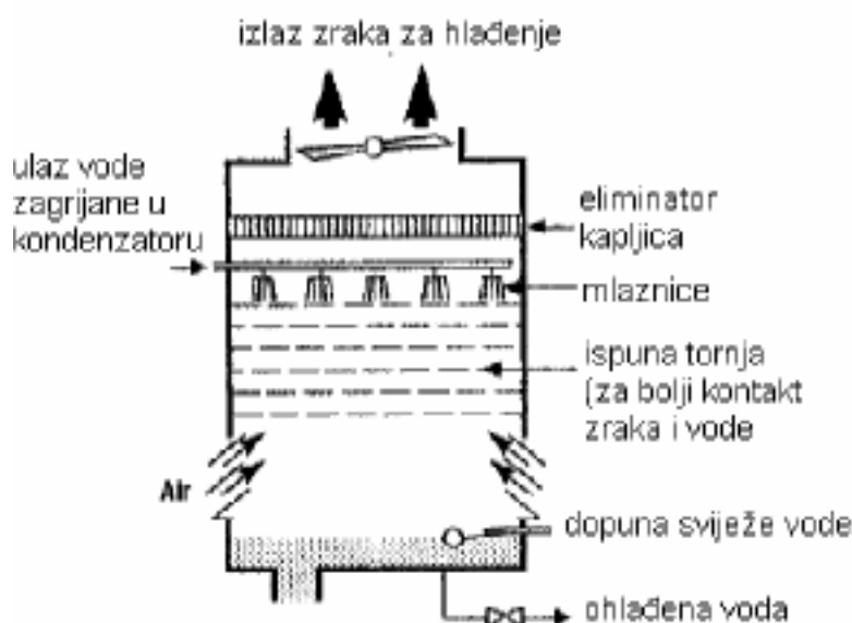
Slika 47: Prikaz rada rashladnog tornja
