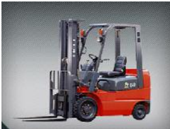
Slika 29: Viličari za manipulaciju paletama
