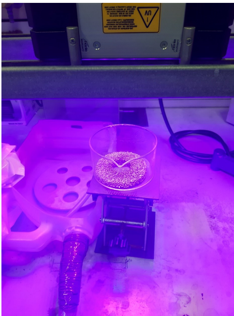
Slika 29. Sterilizacija keramičkog vijenca pod UV lampom
