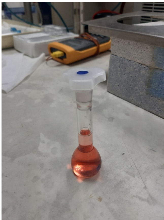
Slika 35. Tikvica za razrjeđivanje otopine Kongo crvenila
