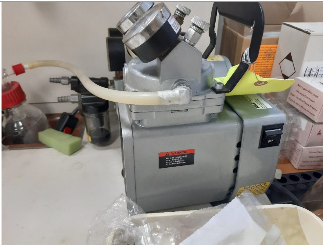
Slika 20. Vakuumska pumpa korištena pri filtraciji
