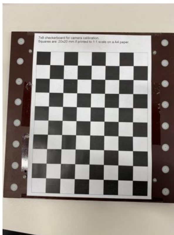
Slika 23. Šahovnica za kalibraciju kamere
