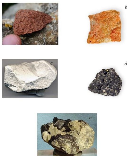
Slika 1. Minerali za dobivanje aluminijske legure: a Boksit, b Alunit, c Kaolinit, d Leucit, e Nefelin[3–7]
