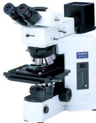
Slika 17. Sastavni dijelovi svjetlosnog mikroskopa: 1 Tijelo mikroskopa, 2 Stolić, 3 Dijelovi za fokusiranje slike, 4 Sustava za iluminaciju, 5 Optičke komponente [24]
