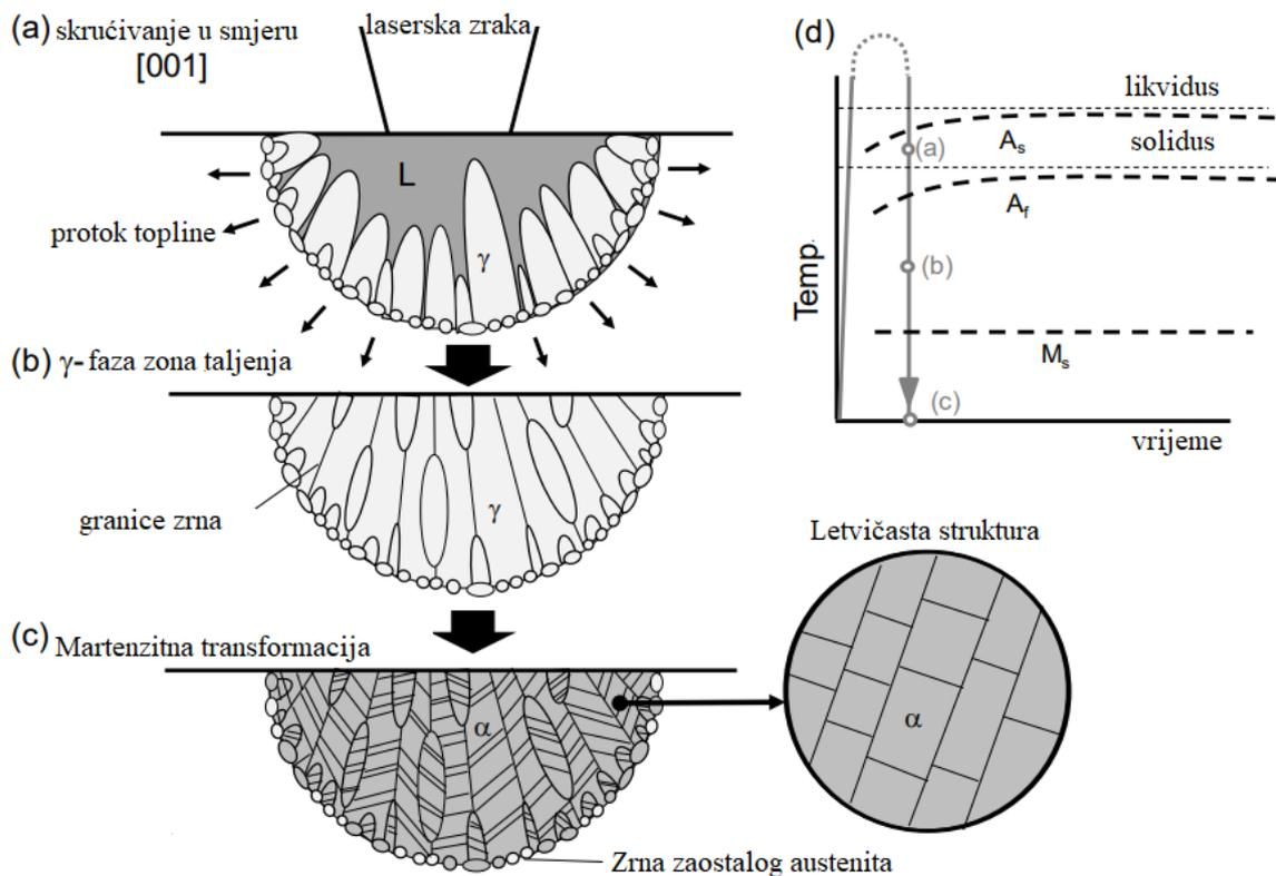
Slika 14. Formiranje mikrostrukture MARAGING čelika SLM postupkom [62]
