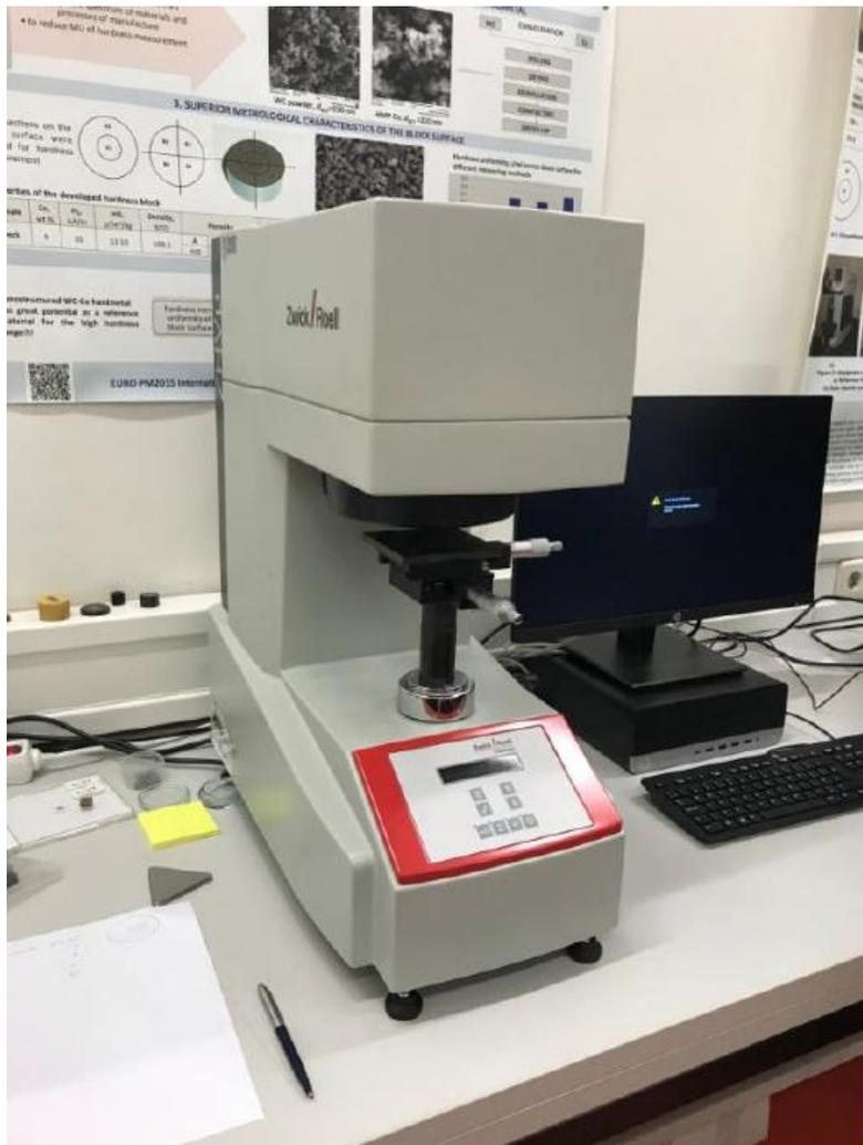
**Slika 19. INDENTEC ZHV  $\mu$  tvrdomjer**
