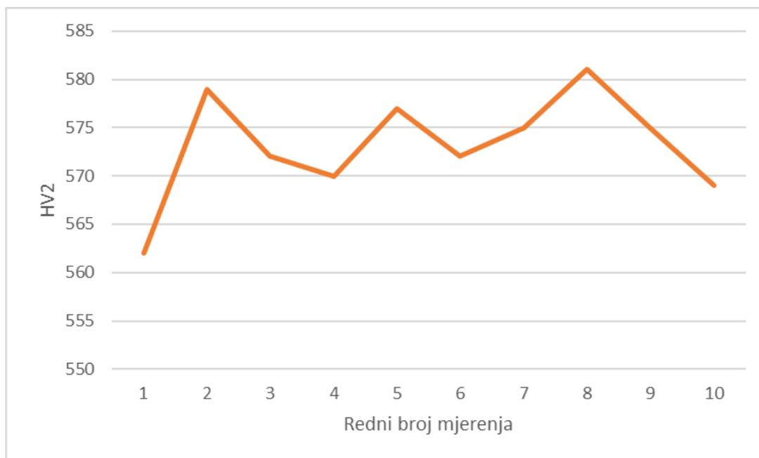
**Slika 23. Raspodjela površinske tvrdoće za uzorak broj 5**
