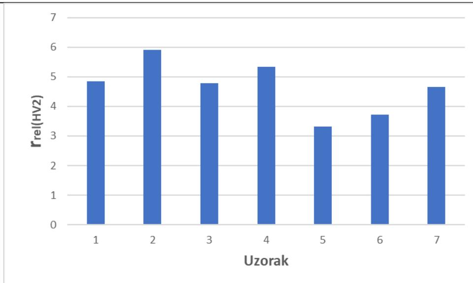
Slika 24. Dijagram nejednolikosti površinske tvrdoće za metodu HV2
