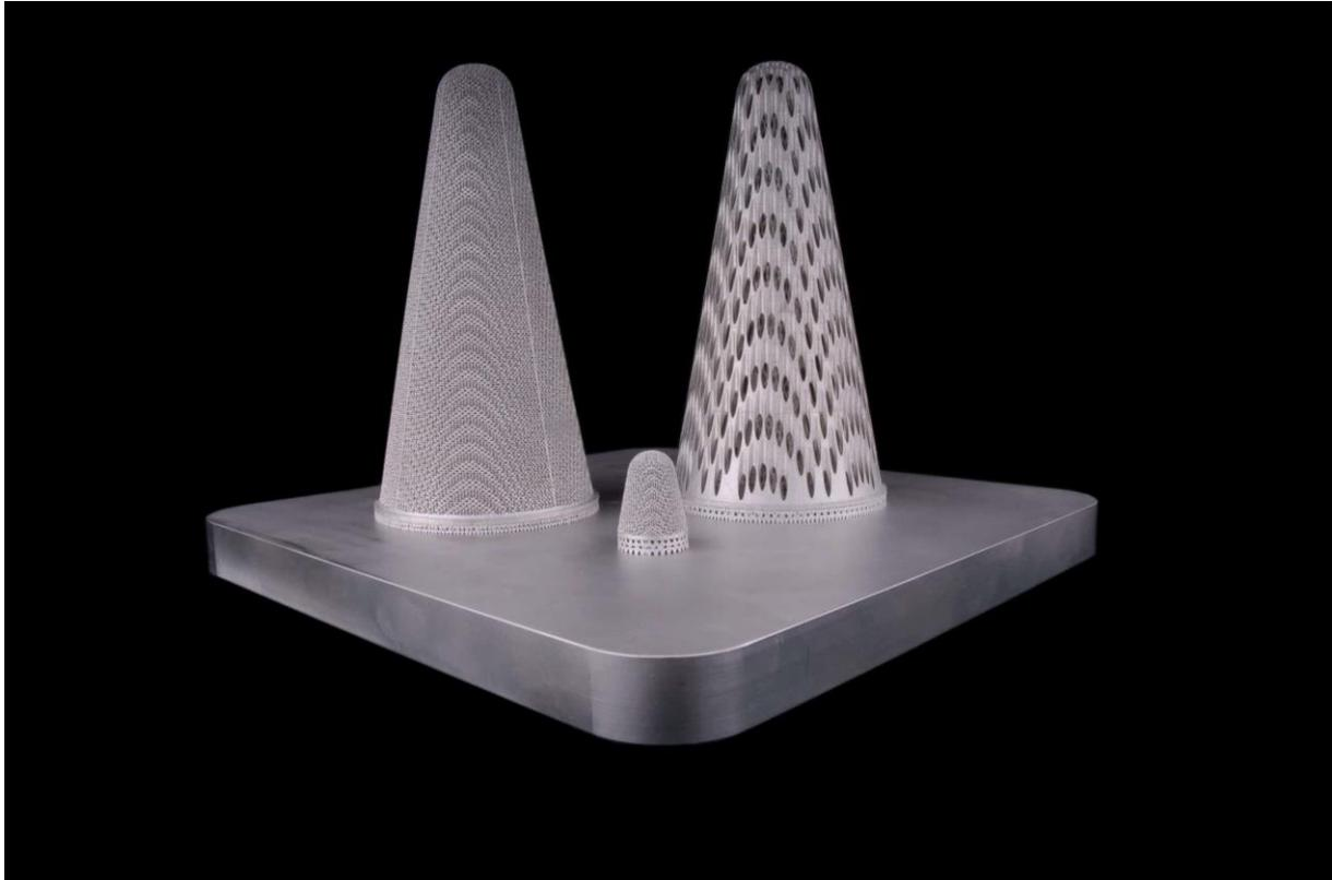
**Slika 11. Croft filteri dobiveni aditivnom proizvodnjom [60]**
