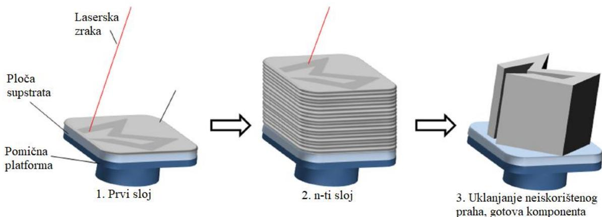
Slika 2. Aditivna proizvodnja SLM postupkom [2]
