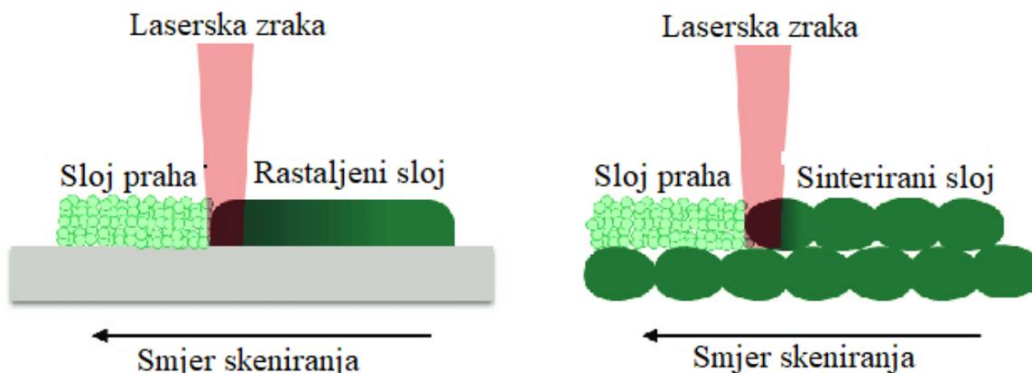
Slika 1. Razlika između SLS i SLM tehnologija aditivne proizvodnje [55]
