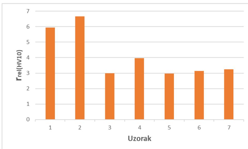
Slika 25. Dijagram nejednolikosti površinske tvrdoće za metodu HV10
