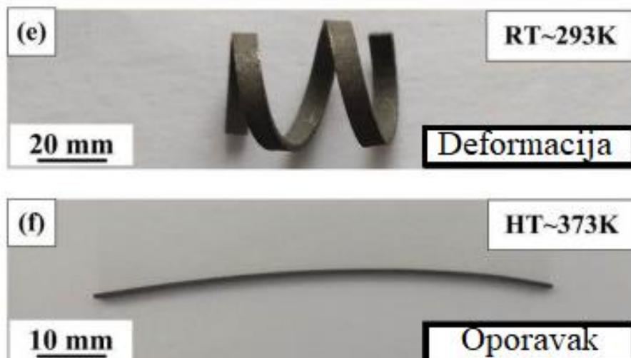
Slika 8. Legura sa prisjetljivosti oblika dobivena SLM postupkom [57]
