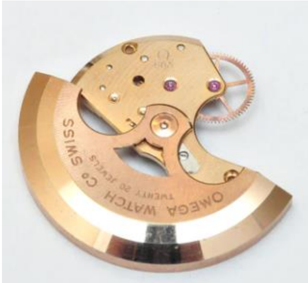
Slika 41. Mehanizam automatskog navijanja sata [21]
