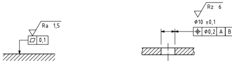
Slika 2.17 Zahtjev na površinsku hrapavost na okviru s geometrijskim tolerancijama [1]
