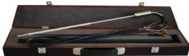
**Slika 11.** Etalonski platinski otpornički termometar (SPRT), Accu Mac, AM 1950 [17]
