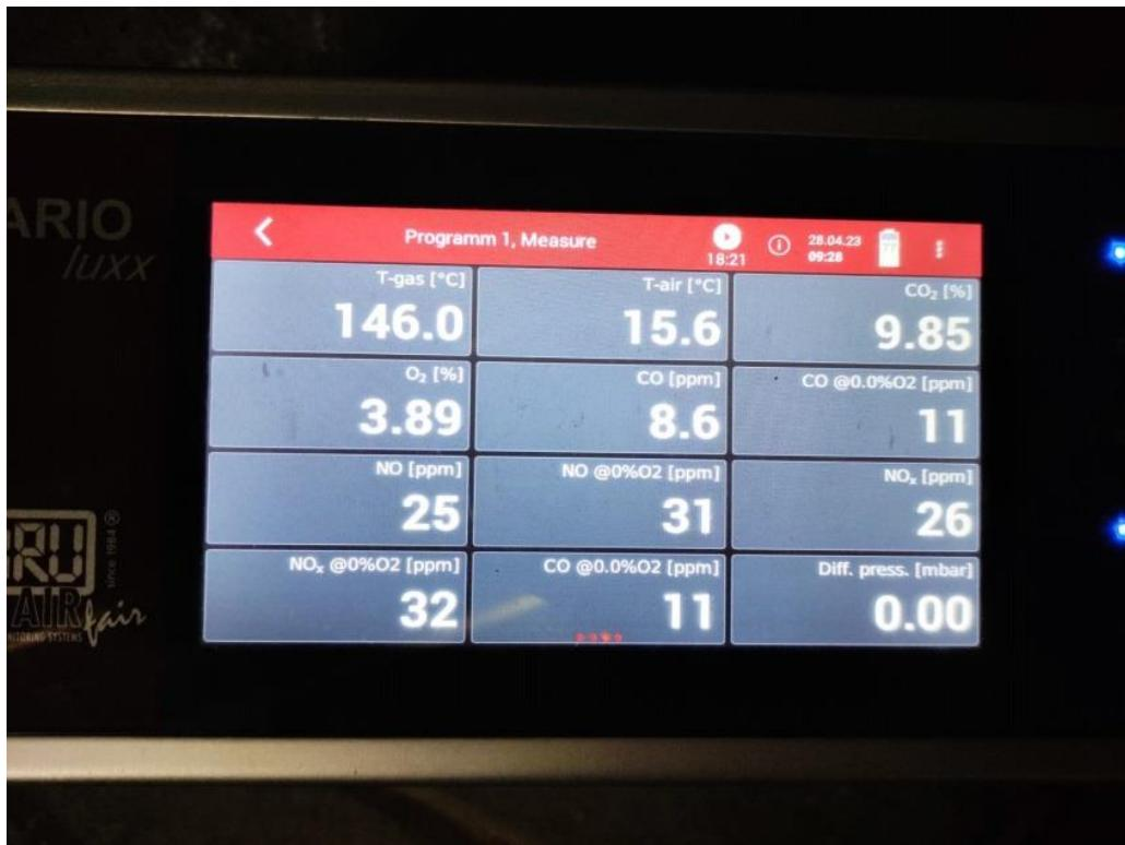
Slika 5. Zaslon mjernog instrumenta za praćenje mjerena
