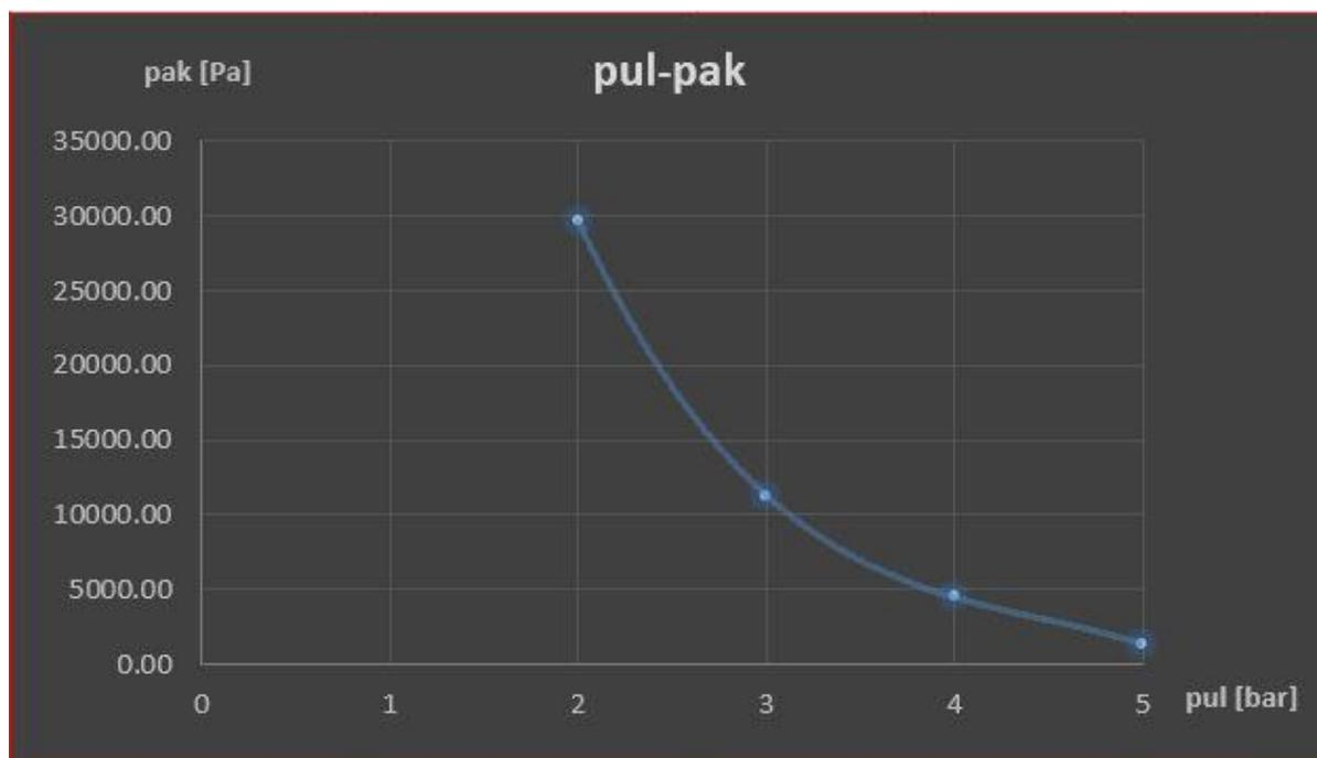
Slika 24. Ovisnost akceleracijske komponente o ulaznom tlaku.
