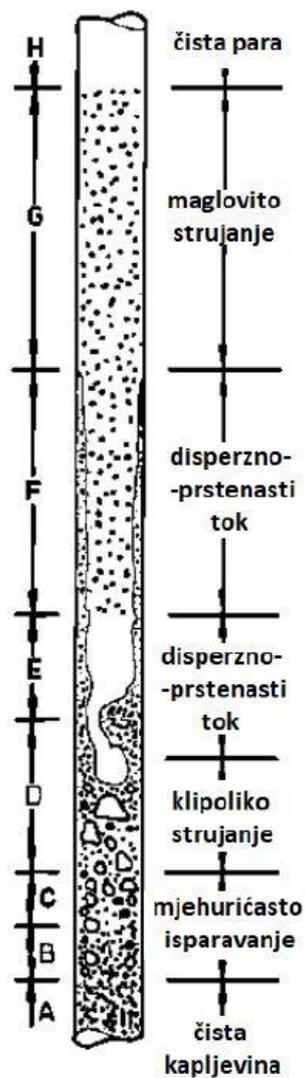
**Slika 1. Oblici dvofaznog strujanja kroz vertikalnu cijev.**
