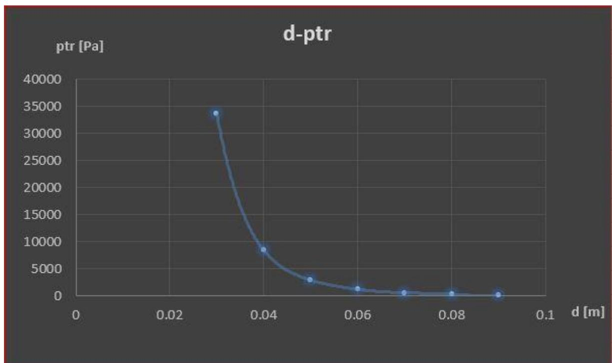
Slika 22. Utjecaj promjera cijevi na komponentu trenja.
