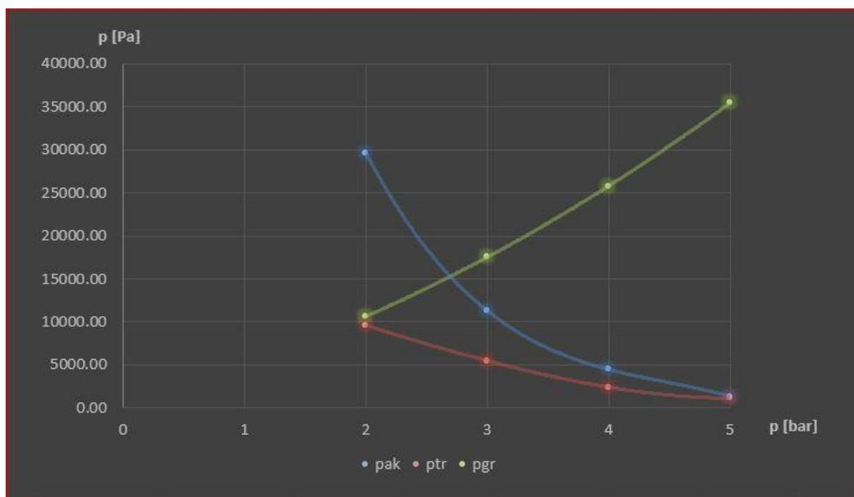
Slika 27. Odnos komponenti pada tlaka o ulaznom tlaku.
