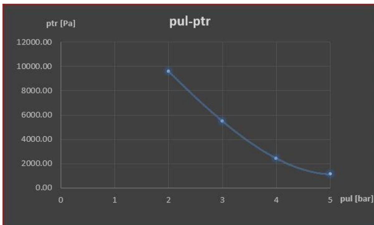
Slika 25. Ovisnost komponente trenja o ulaznom tlaku.
