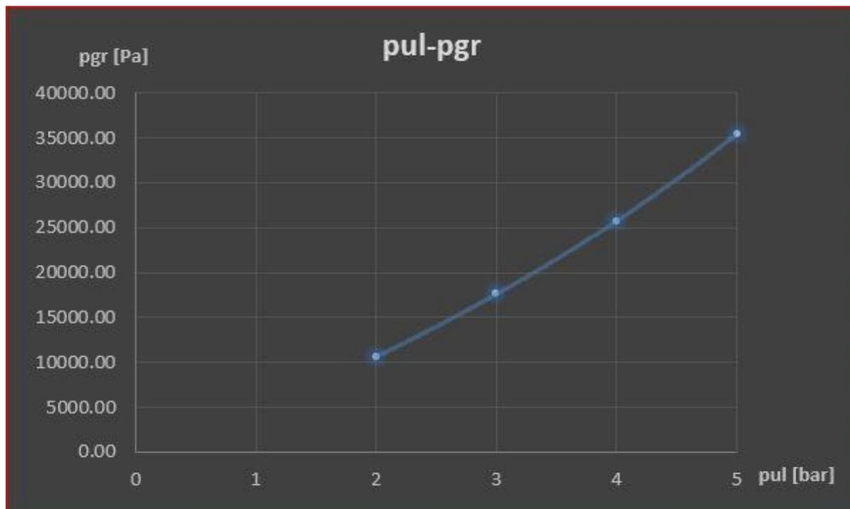
Slika 26. Ovisnost gravitacijske komponente o ulaznom tlaku.
