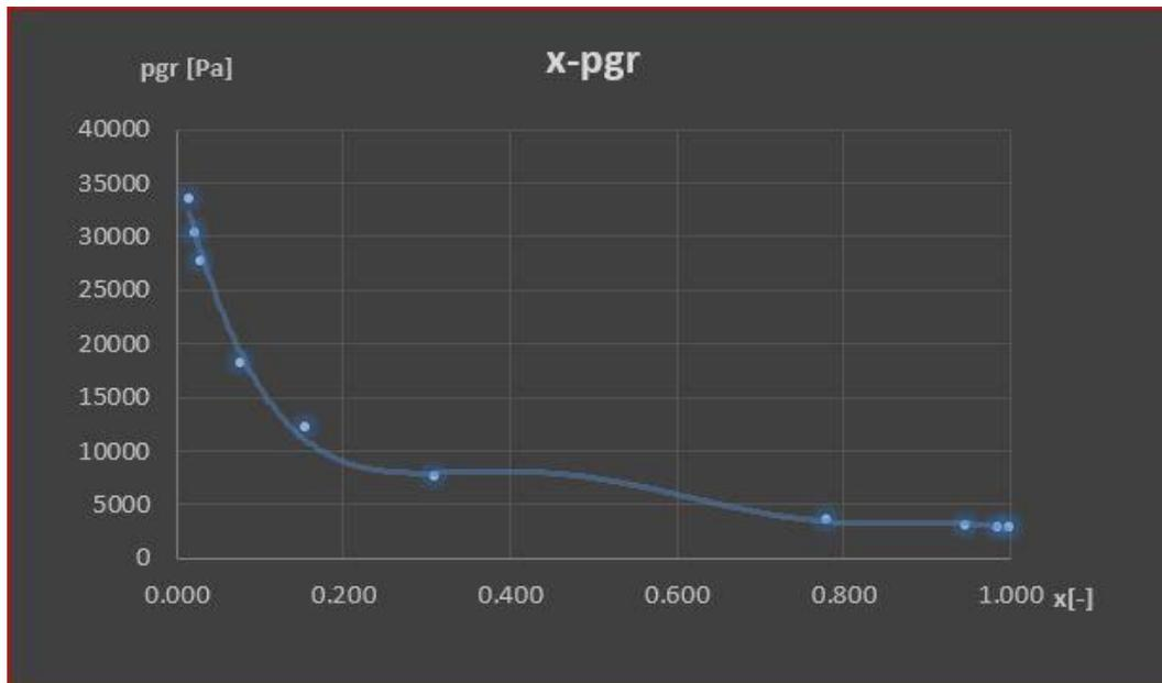
**Slika 19. Ovisnost gravitacijske komponente pada tlaka o masenom udjelu pare.**
