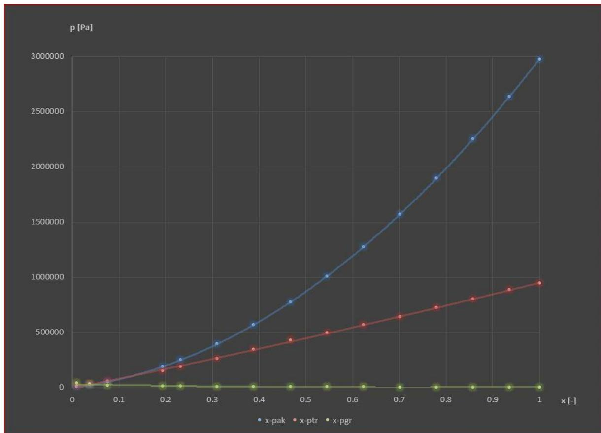
**Slika 11. Ovisnost svih komponenti pada tlaka o masenom udjelu pare  $x$ .**
