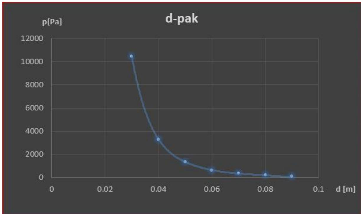
Slika 21. Ovisnost akceleracijske komponente o promjeru cijevi.
