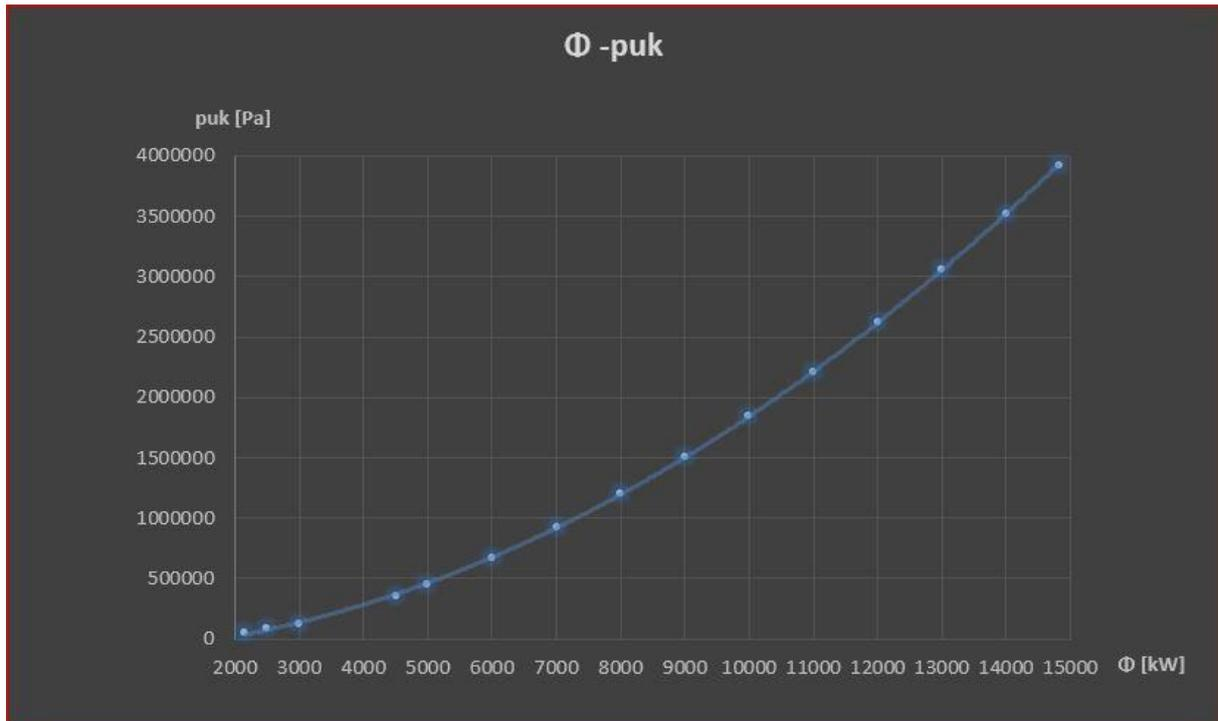
**Slika 7. Ovisnost ukupnog pada tlaka o dovednoj toplini.**
