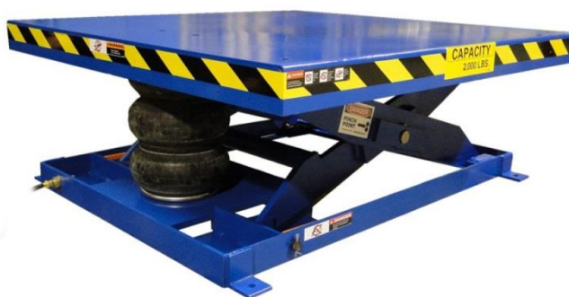
Slika 8. Podizna platforma sa pneumatskim pogonom.
