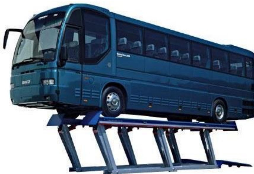
Slika 4. Podizna platforma sa zglobnim paralelogramom.
