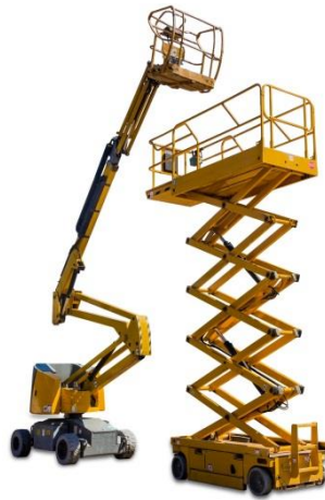
Slika 3. Radna platforma izvedena kao teleskopski stup i škarasti mehanizam.
