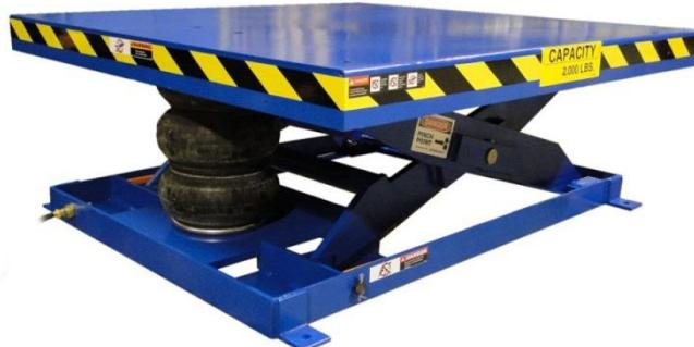
Slika 8. Podizna platforma sa pneumatskim pogonom.
