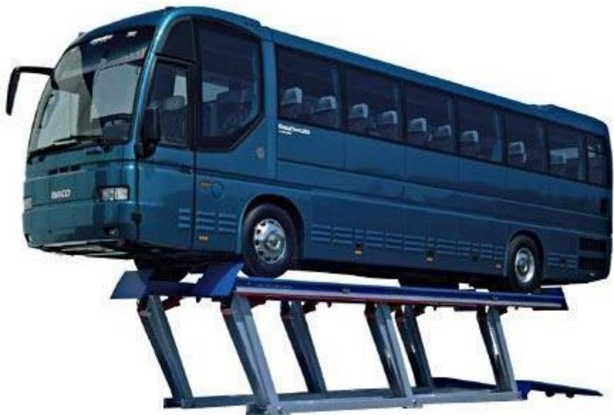
**Slika 4.** Podizna platforma sa zglobnim paralelogramom.
