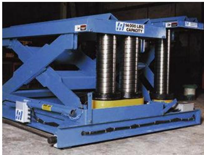
Slika 7. Podizna platforma s spiralnim vođenjem.
