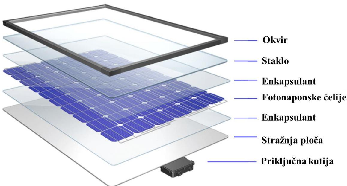
**Slika 14.** Slojevi konvencionalnog FN modula [69]
