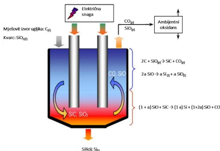
Slika 8. Shematski prikaz MG – silicij reaktora [58]
