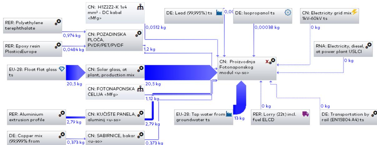
Slika 24. Plan modela proizvodnje fotonaponskog modula u Kini
