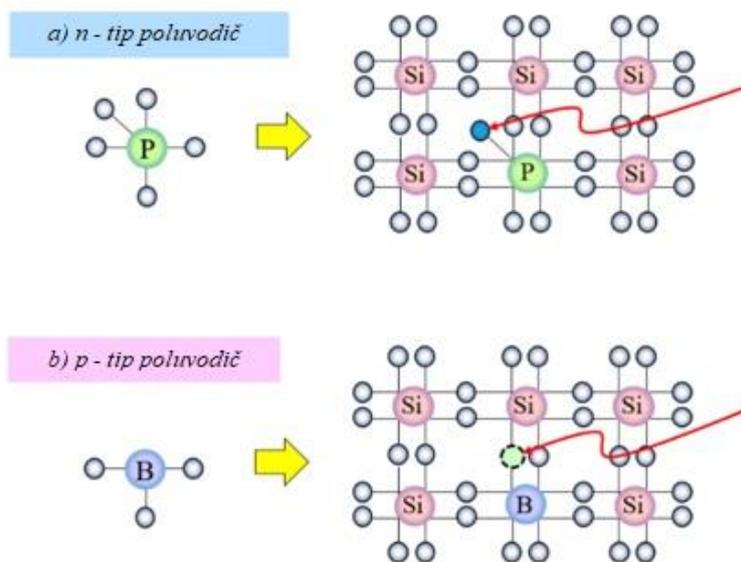
Slika 6. Dopirani silicij: a) *n*-tip poluvodiča, b) *p*-tip poluvodiča [55]
