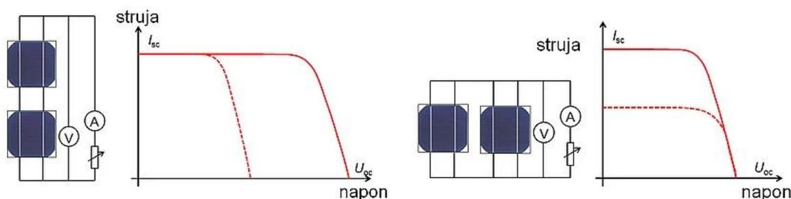
Slika 12. I-U karakteristika spojenih fotonaponskih ćelija u serijski i paralelni spoj [64]
