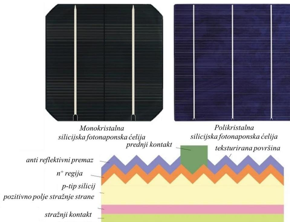
Slika 10. Monokristalna i polikristalna silicijska fotonaponska ćelija [60]
