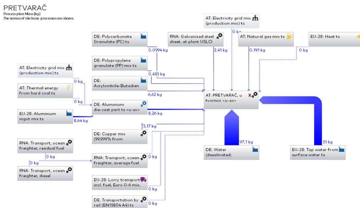
Slika 26. Plan modela proizvodnje pakiranog pretvarača u Austriji
