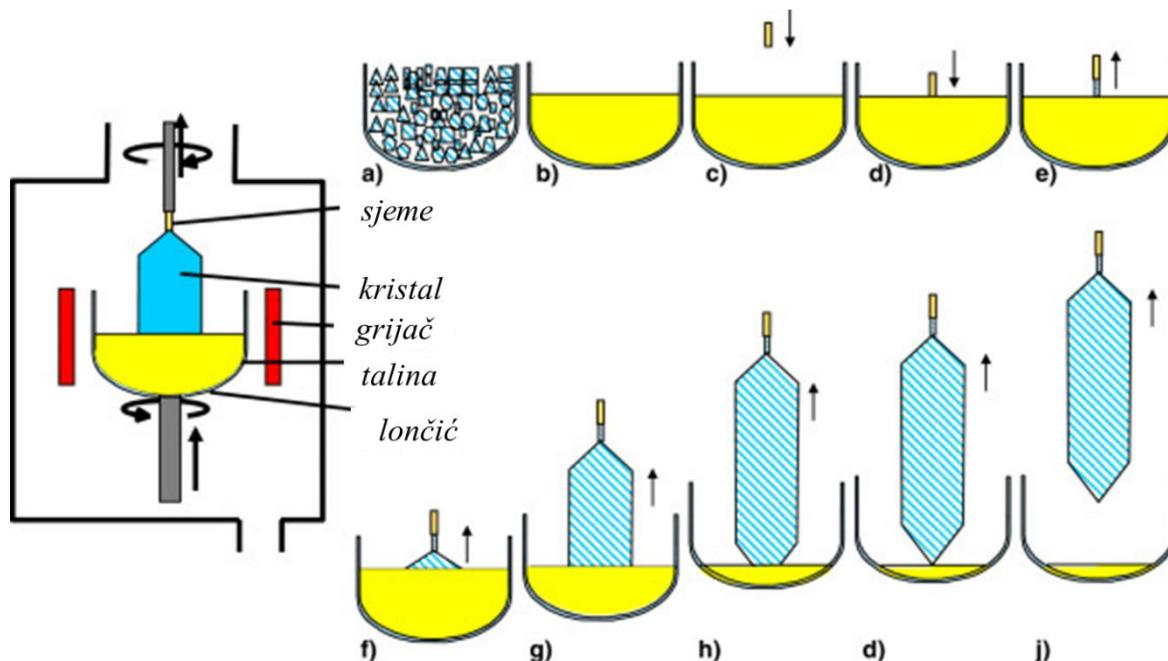
Slika 9. Czochralskijev postupak proizvodnje monokristalnog silicija [59]
