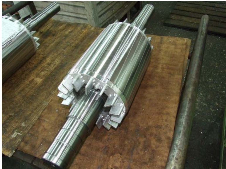
Slika 3.4 Sklop rotora i vratila
