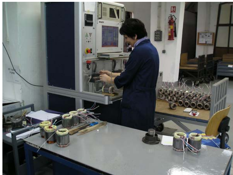
Slika 4.1 Uređaj za kontrolu u namataonici
