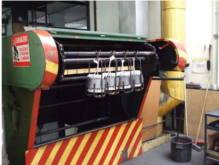
Slika 3.2 Uređaj za impregnaciju
