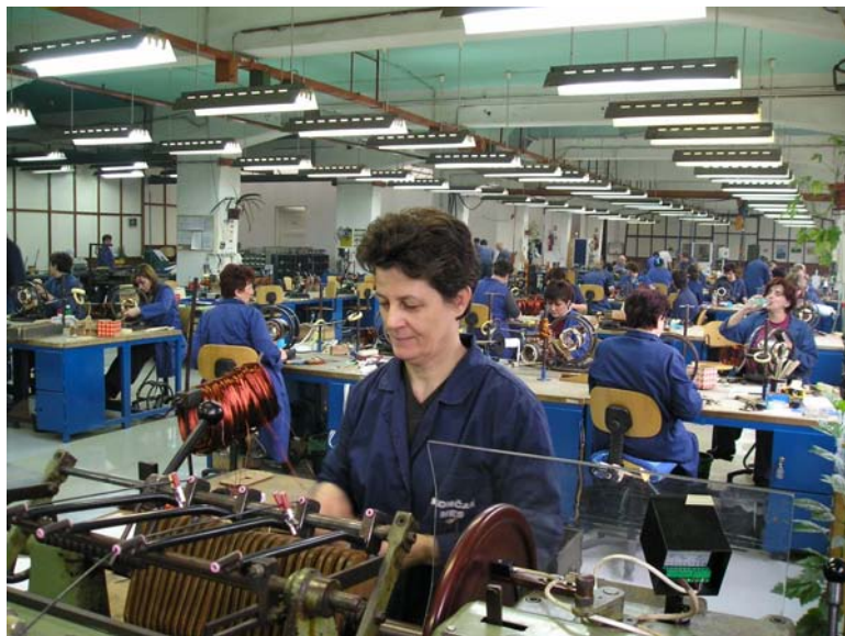
Slika 3.1 Ručno namatanje u namataonici
